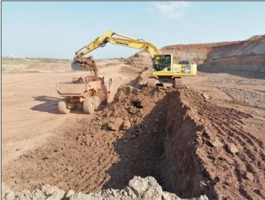
Abbautechnologie Kettenbagger / Muldenkipper
