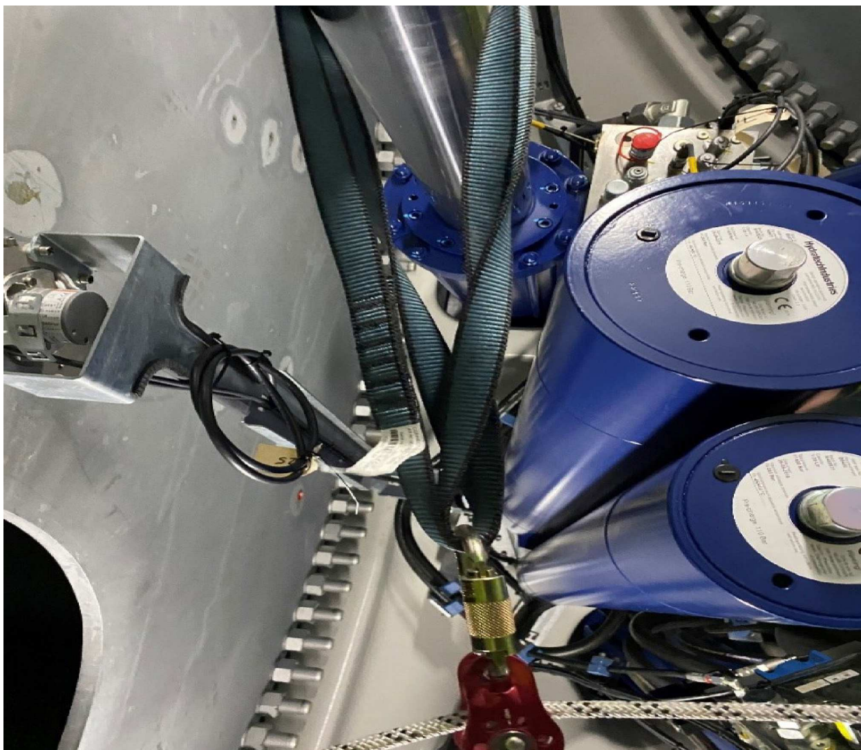
Abbildung 7.28: Das Seil wird durch eine Rolle geführt, die an einem Pitchzylinder aufgehängt ist.
