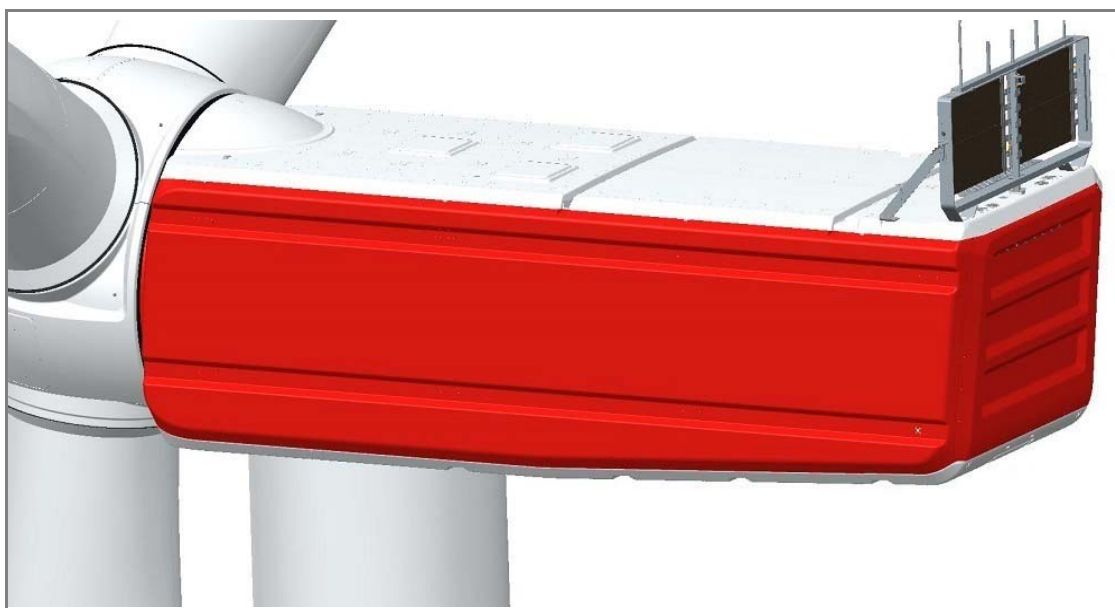
Abb. 2: Beispielhafte Kennzeichnung Maschinenhaus Delta4000 mit roter Tageskennzeichnung
