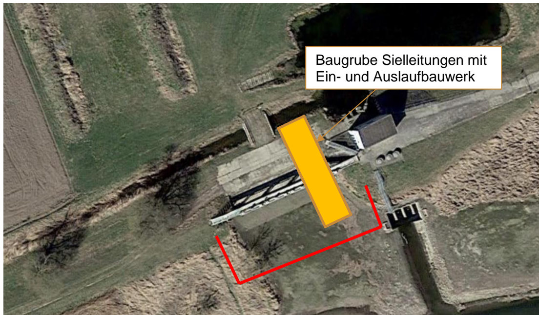
Abbildung 19: Standort Baugrubenumschließung für die Bauphase
