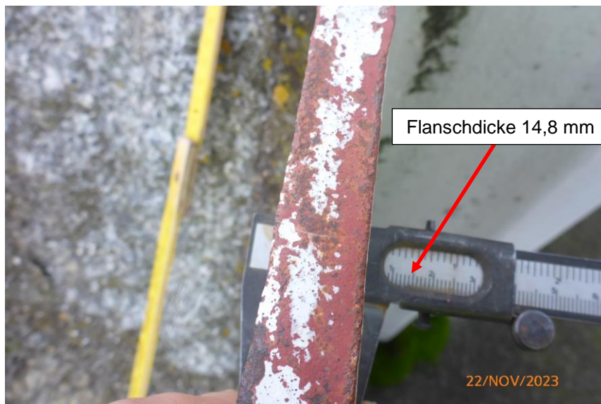
Abbildung 8: Spundwandkontrolle, Messungen vor Ort
