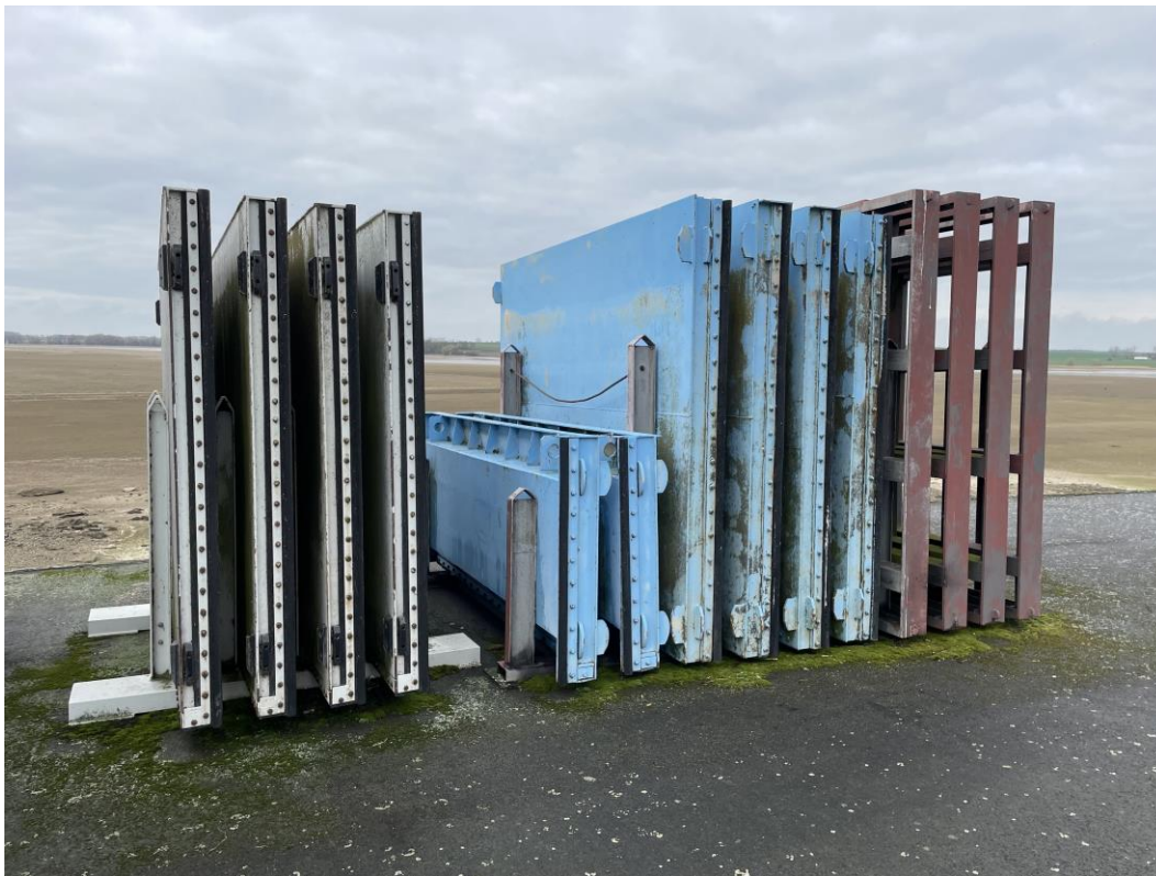
Abbildung 3: Revisionsverschlüssen, Blickrichtung Westen
