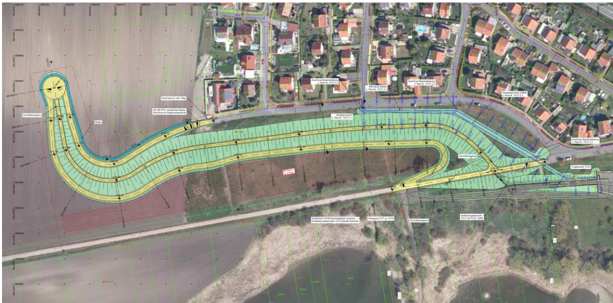
Abbildung 28: Lageplanauszug Schutzdamm Straußfurt (TO17) mit Anschluss an Hochwasserentlastungsanlage (TO14)
