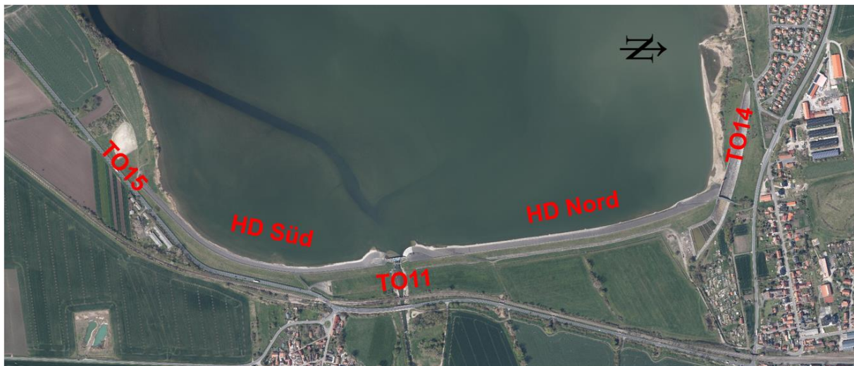
Abbildung 9: Bestehendes Absperrbauwerk des HRB Straußfurt: Hauptdamm (HD Nord und Süd), Abschlussbauwerk (TO11) und Hochwasserentlastungsanlage (TO14) sowie Bereich für die geplante Verlängerung des Hauptdammes (TO15)
