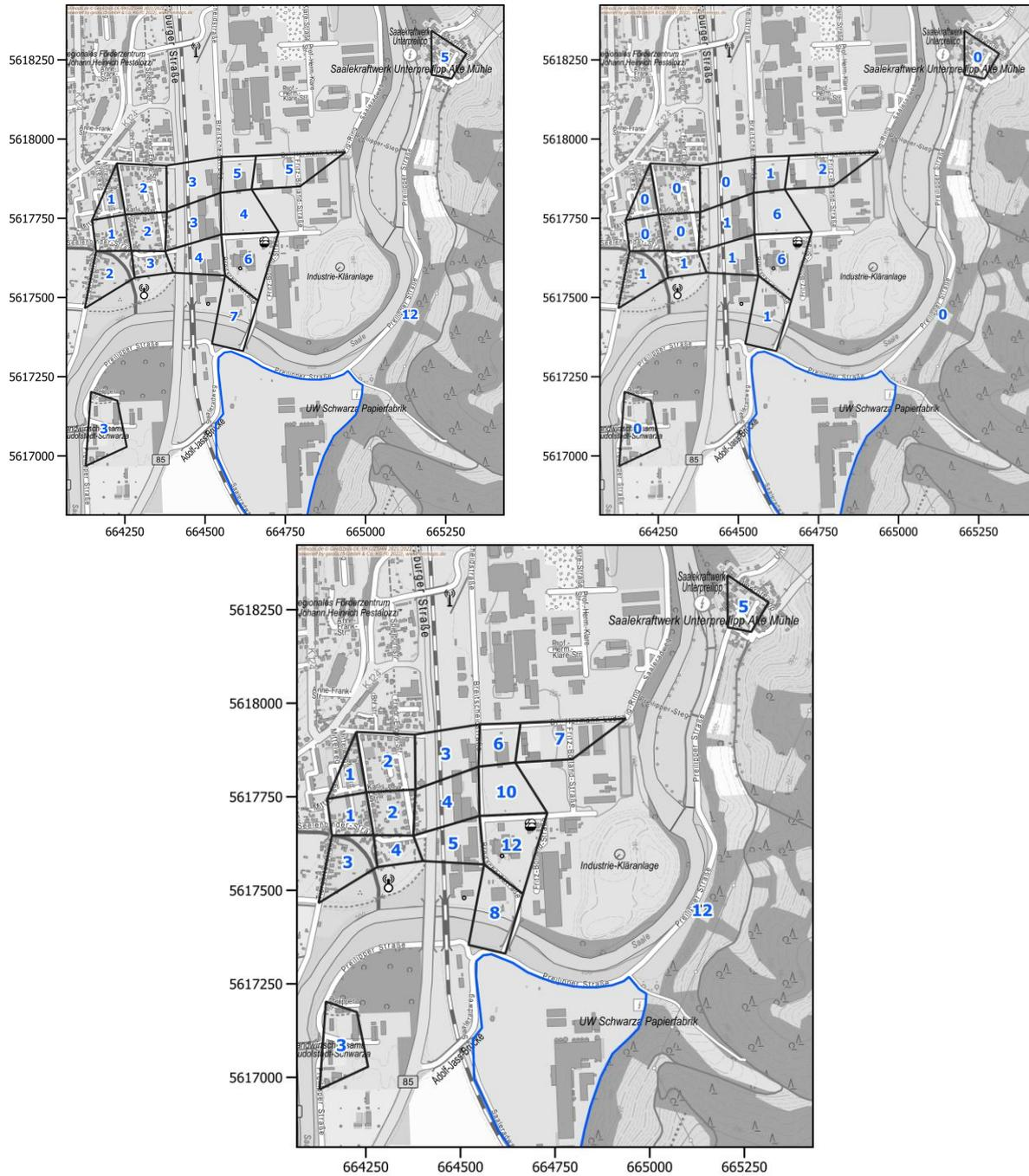
**Abbildung 7-4:** Durch Rasterbegehungen bestimmte Vorbelastung durch die Geruchsbelastung „Papierfabrik“ (oben links), „Kläranlage“ (oben rechts) und die Summe aus beiden (unten) als Geruchsstundenhäufigkeit in % der Jahresstunden, **Ist-Zustand**. Das Betriebsgelände ist blau markiert. (Kartengrundlage: onmaps.de © GeoBasis-DE/BKG 2022).
