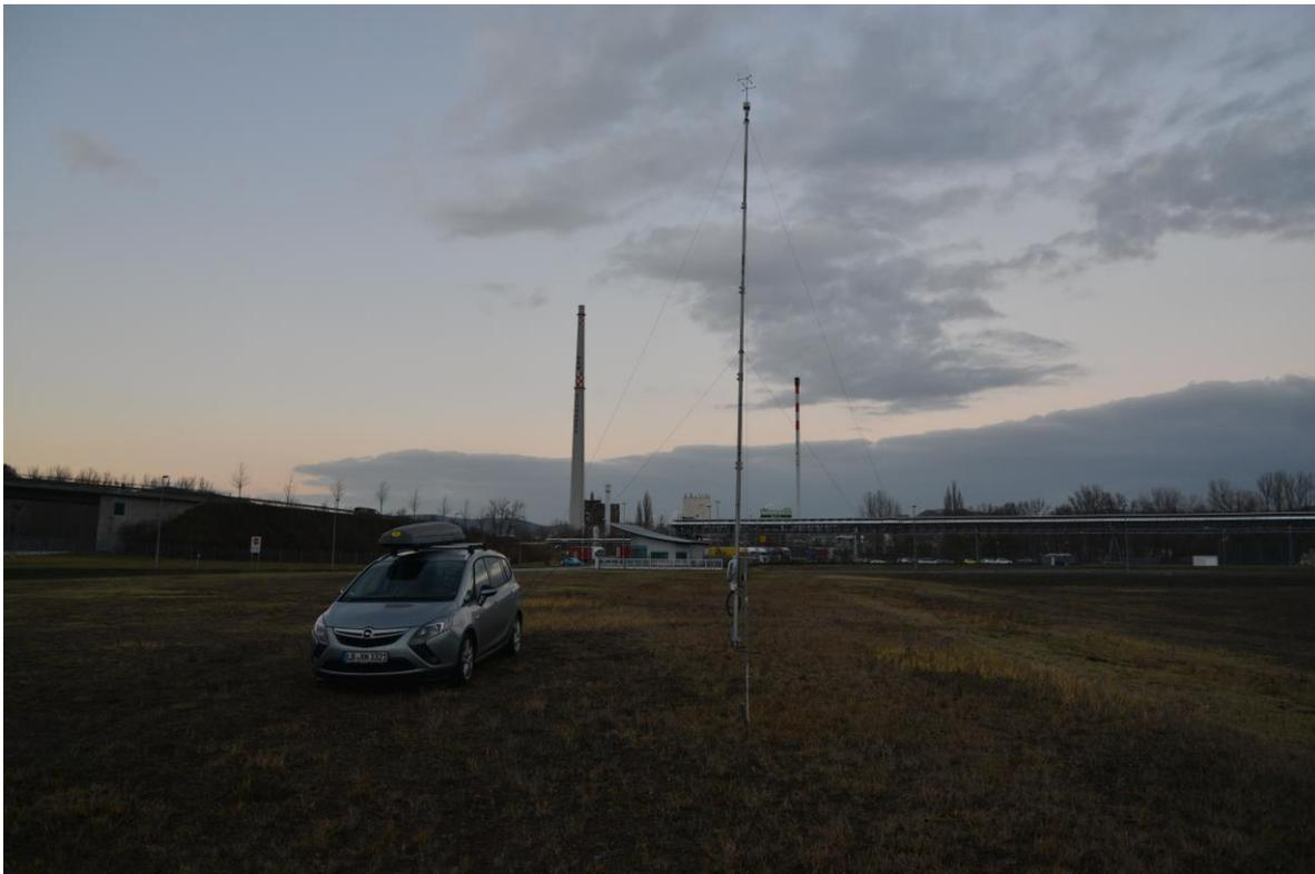
**Abbildung 6-3:** Messmast der Windmessanlage auf dem Gelände der Papierfabrik Adolf Jass Schwarza GmbH.
