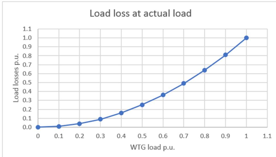
Abbildung 4-2: Transformatorlastverluste – Skalierung
