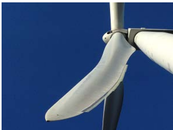
Abb. 1: Serrations (gezackte Blatthinterkanten) an einer WEA
