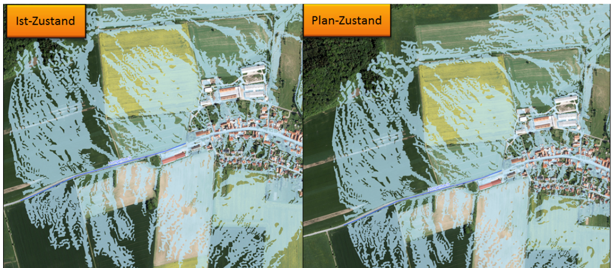
Abbildung 79: Vergleich von Ist- und Plan-Zustand der Überschwemmungsfläche oberhalb von Gutendorf
