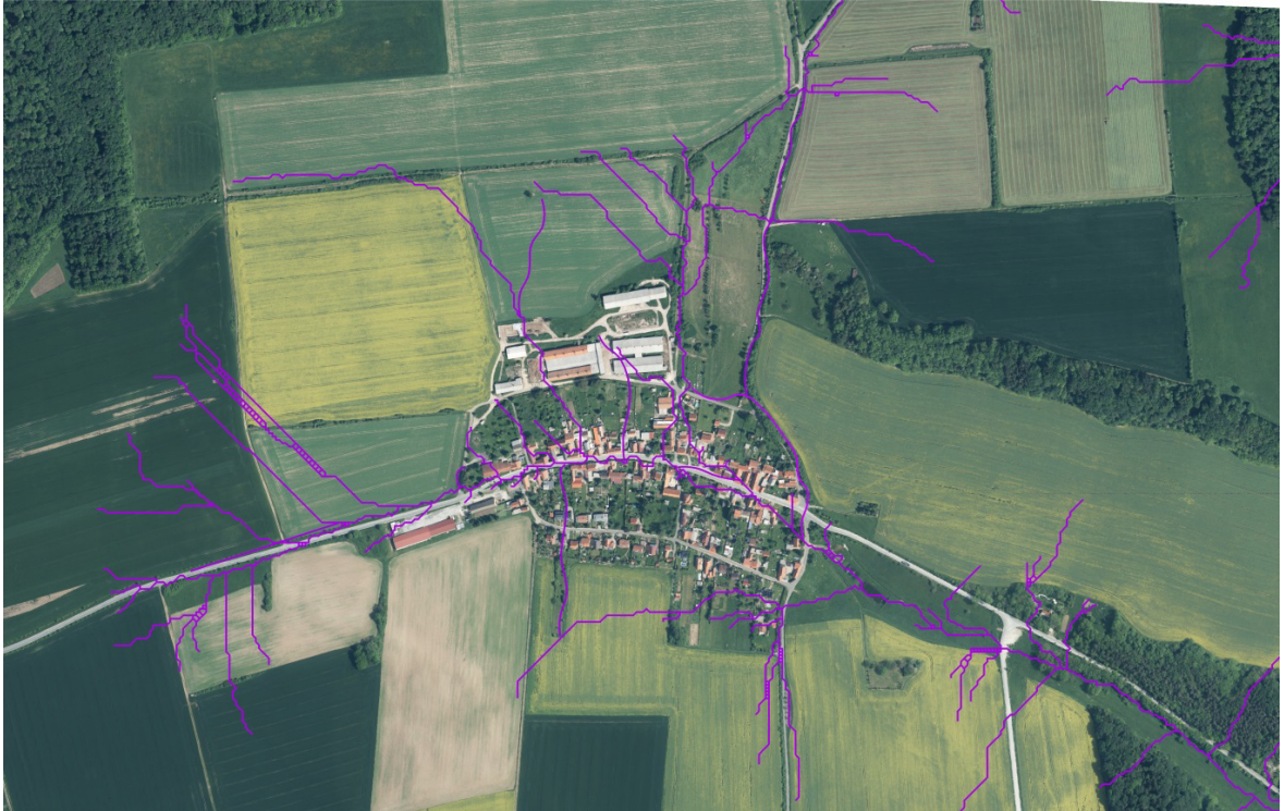
Abbildung 32: Ermittelte natürliche Fließwege im Einzugsgebiet von Gutendorf („Flow Accumulation“)
