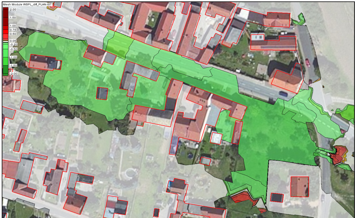
Abbildung 81: Wasserspiegellagendifferenz (Ist/Plan) am Ortsausgang von Gutendorf in Richtung Bad Berka für HW HQ 100
