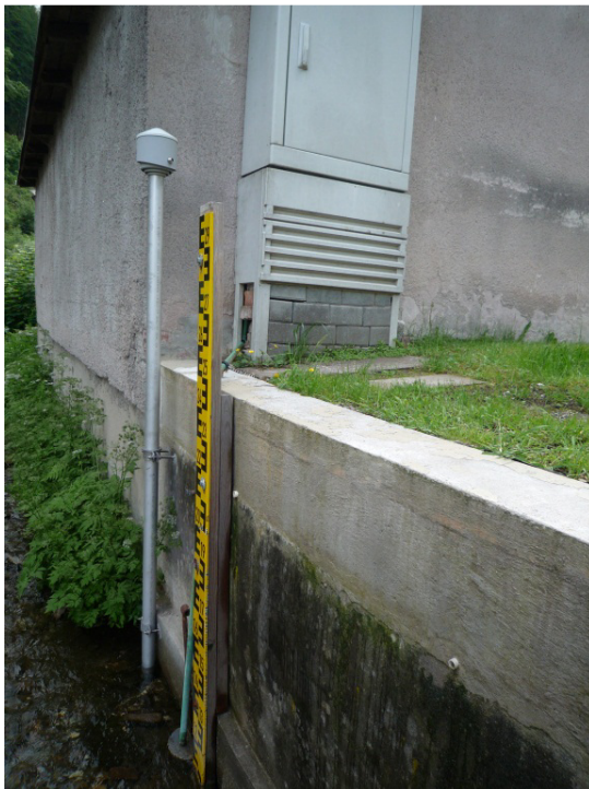
Abbildung 66: Lattenpegel mit dem OTT ecoLog 500 Datensammler mit integriertem GSM/GPRS-Modem zur Datenfernübertragung der Fa. OTT Hydromet GmbH (Prognosepegel)
