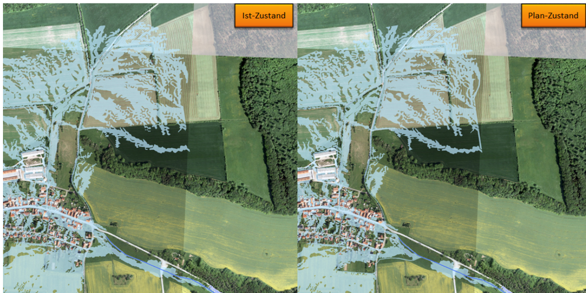
Abbildung 80: Vergleich von Ist- und Plan-Zustand der Überschwemmungsfläche unterhalb von Gutendorf
