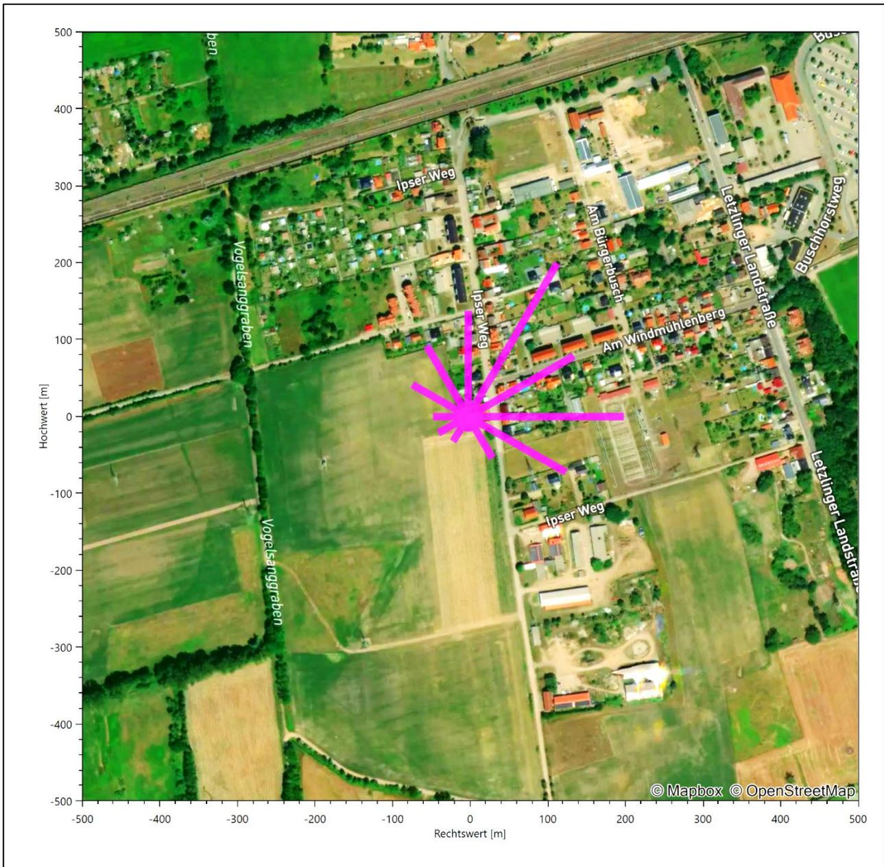
**Abbildung 32: Verteilung der effektiven aerodynamischen Rauigkeiten auf die Windrichtungssektoren für die Station Gardelegen**
