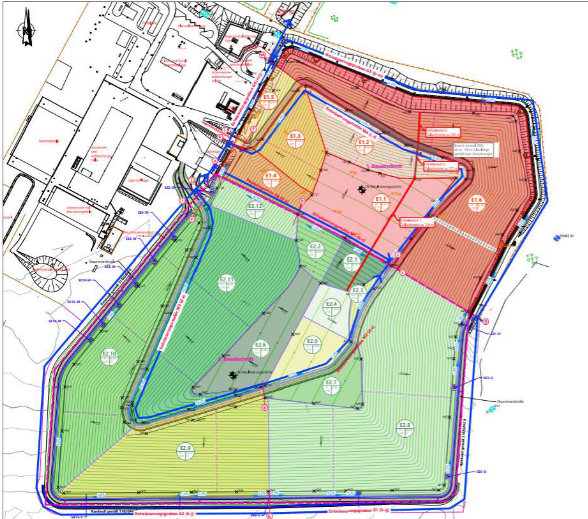
Abbildung 43: Fließwege des Oberflächenwassers aus den Einzugsgebieten 1. BA und 2. BA in Richtung Versickerungsbecken (Quelle: Bestandslageplan 3182GP142a [87])
