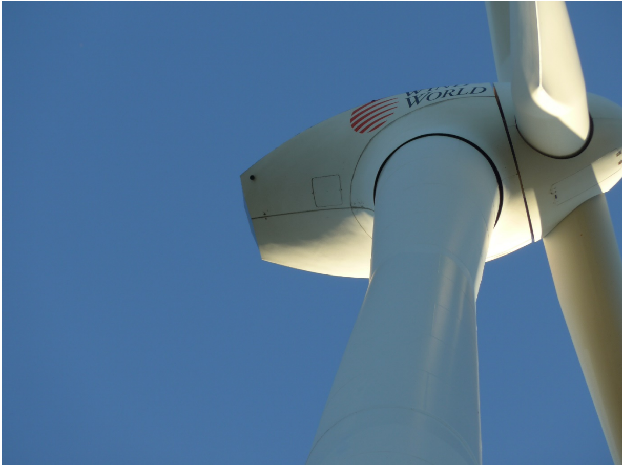
Abbildung 4: Installiertes Gondelmonitoring in einer der Windworld-Anlagen. Der schwarze Punkt am linken Ende der Gondel ist das Mikrofon.
