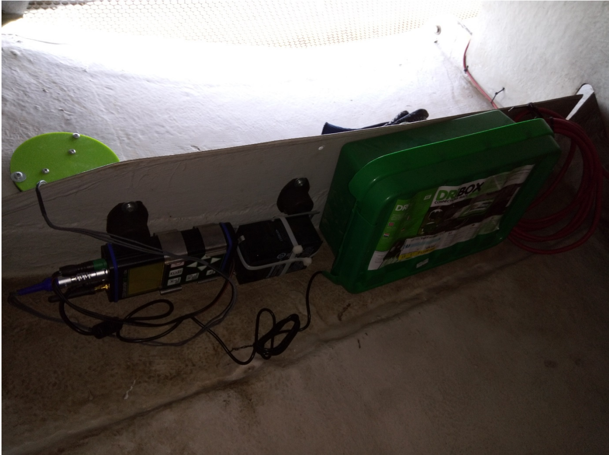
Abbildung 9: Vergitterte Öffnung am Gondelende bei den Windworld-Anlagen. Im Vordergrund das installierte Batcorder-System.
