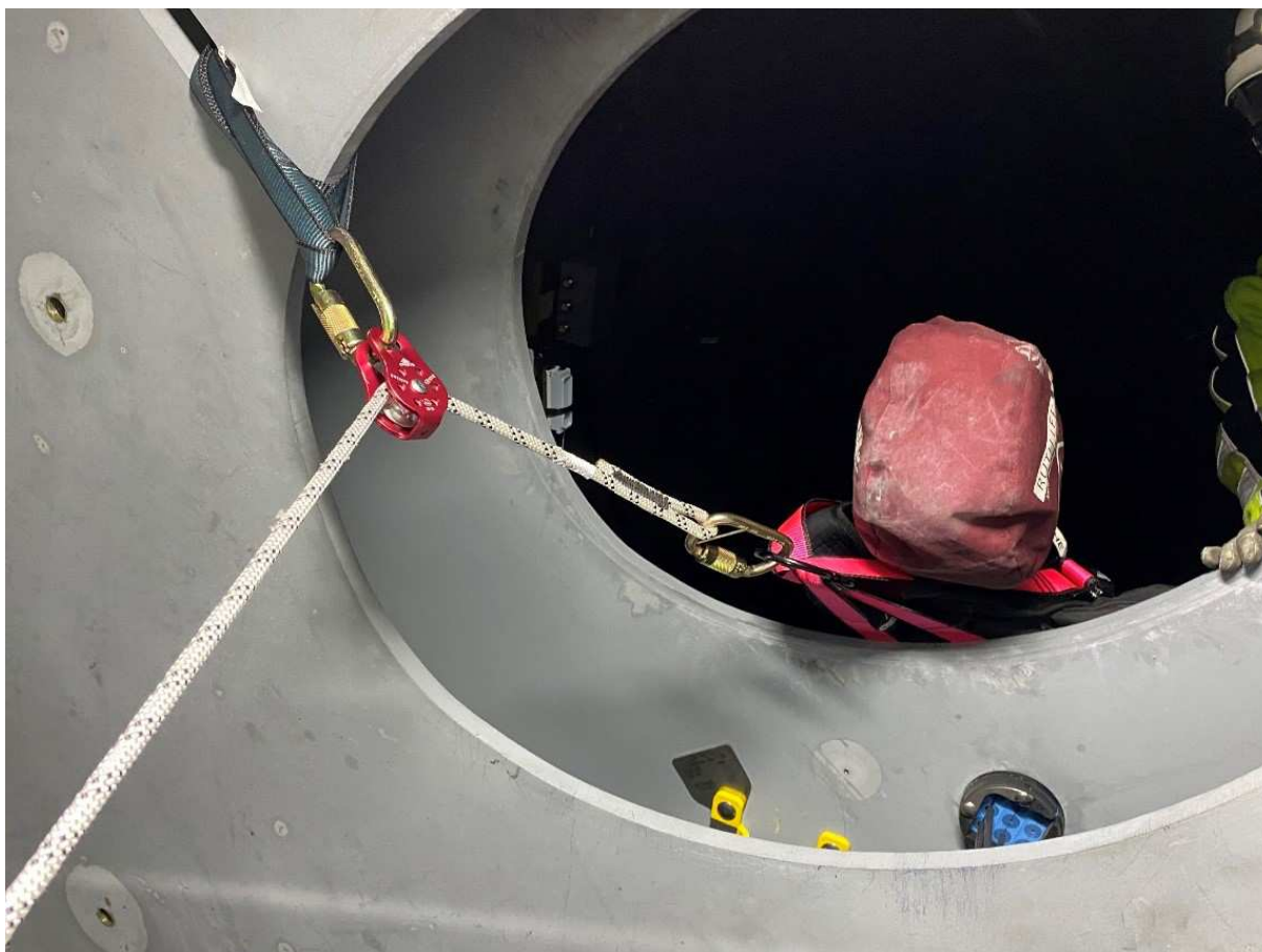
Abbildung 7.26: Das Seil wird durch eine Rolle geführt, die an einem Loch in der Drehmomentplatte aufgehängt ist.
