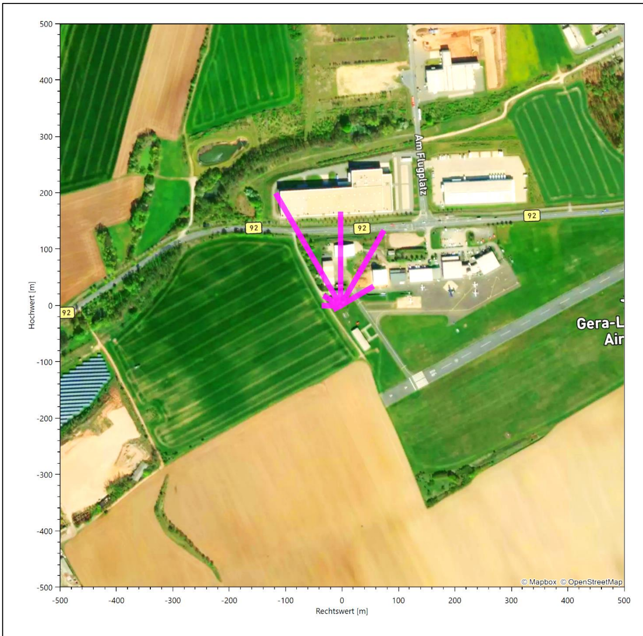
Abbildung 14: Verteilung der effektiven aerodynamischen Rauigkeiten auf die Windrichtungssektoren für die Station Gera-Leumnitz
