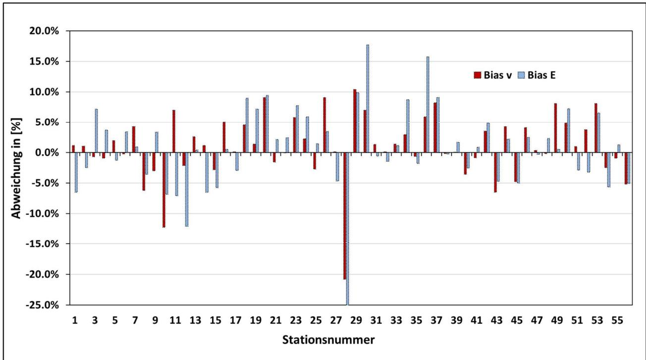
Abb. 4: Bias der mittleren Windgeschwindigkeit (rot) und der mittleren Energiedichte (blau) zwischen den 56 externen Messungen und dem D-3km.M2. Die Messhöhen liegen zwischen 80 m und 140 m ü. G. und das Messintervall beträgt 1 Jahr. Die Verifikation wurde durchgeführt von Dr. Anselm Grötzner von CUBE Engineering GmbH – Part of Ramboll
