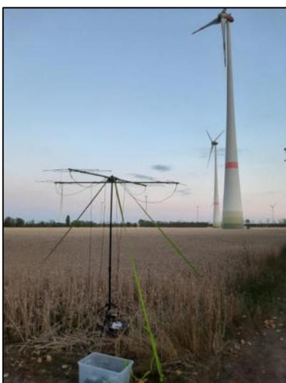
Abbildung 8-19: Stationäres Telemetrieantennenset von 4 Antennen in Nord, Ost, Süd, und Westausrichtung. Aufstellung ausschließlich während der Netzfänge an beiden Netzfang-Standorten.
