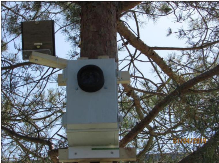
Abbildung 8-5: Dauererfassung in Kunststoffbox mit Solarpanel
