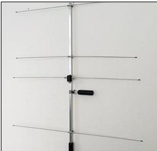
Abbildung 8-17: YAGI 4-Elemente (Telemetrieservice-Dessau)
