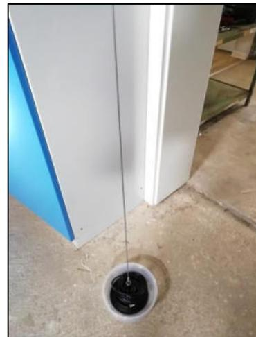
Abbildung 8-18: Autodachantenne mit Magnetfuß
