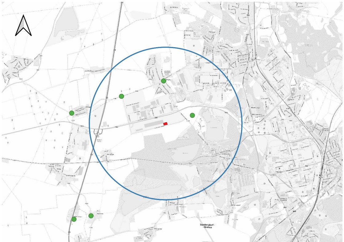
Abbildung 16. Lage der Grundwasserbeschaffenheitsmessstellen (grüne Punkte) [83]; geplanter Standort des EBS-HKW rot markiert, Untersuchungsgebiet blauer Kreis; Hintergrund: [55].
