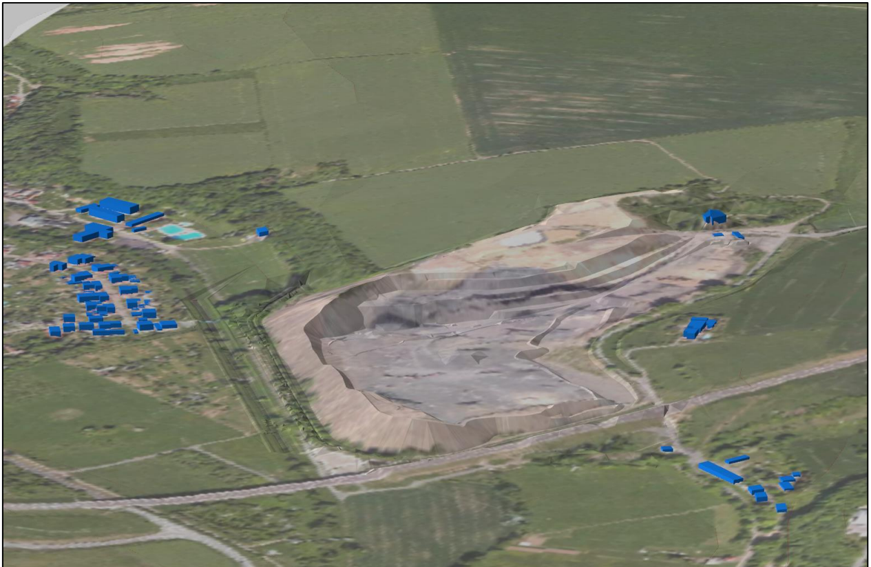
Abbildung 9: 3-D-Modell der Halde Freiesleben-Schacht (IST-Zustand) aus Richtung Westen; gut zu erkennen ist die Haldenböschung (im Bild links, entlang der Betriebsgrenze), welche die Wohnhäuser vom Betriebsgelände abschirmt. Diese soll nur schrittweise abgebaut und wiederverfüllt werden, um die Abschirmwirkung möglichst konstant aufrecht zu erhalten.
