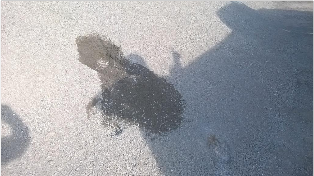
Abbildung 5: Probenahmestelle am Fuße des Haufwerkes; Man erkennt, dass die Oberfläche trocken ist, darunter schließt sich feuchtes Material an
