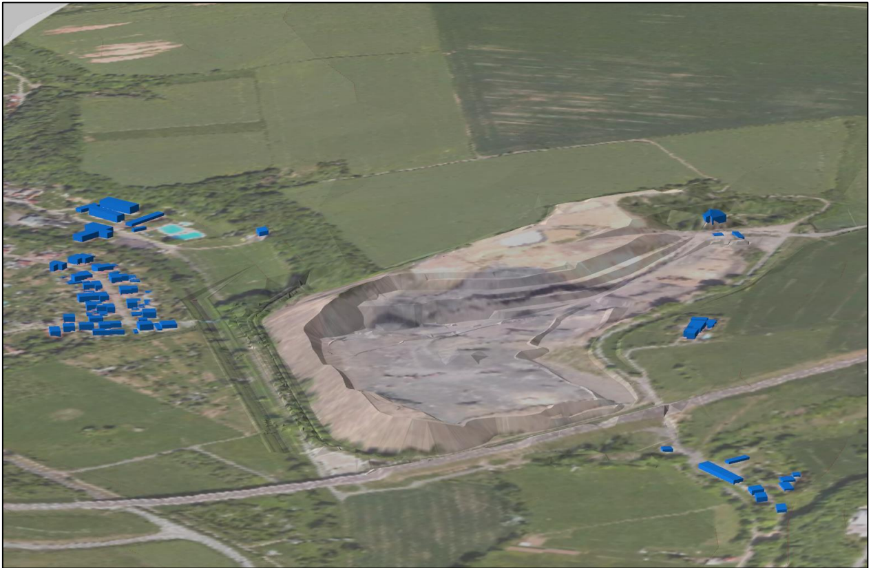
Abbildung 3: 3-D-Modell der Halde Freiesleben-Schacht (IST-Zustand) aus Richtung Westen; gut zu erkennen ist die Böschung, welche die Wohnhäuser (im Bild blau dargestellt) vom Betriebsgelände abschirmt. Diese soll nur schrittweise abgebaut und wiederverfüllt werden, um die Abschirmwirkung möglichst konstant aufrecht zu erhalten.
