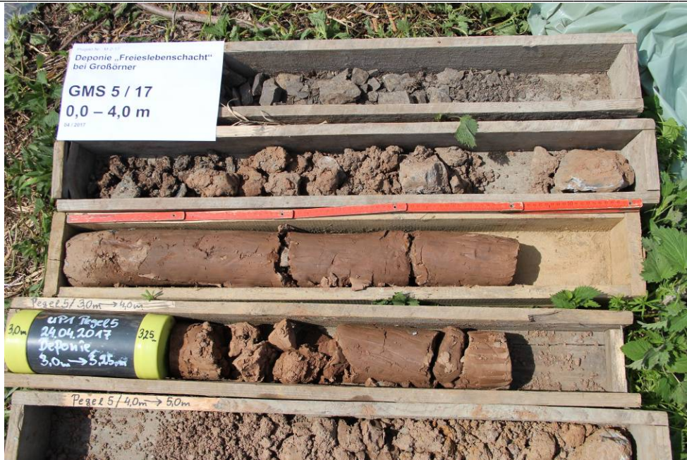
Abbildung 17: Bohrung GWM 5, t = 0 – 4,0 m unter GOK
