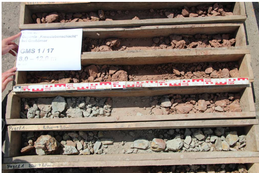
Abbildung 3: Bohrung GWM 1, t = 8,0 – 12,0 m unter GOK
