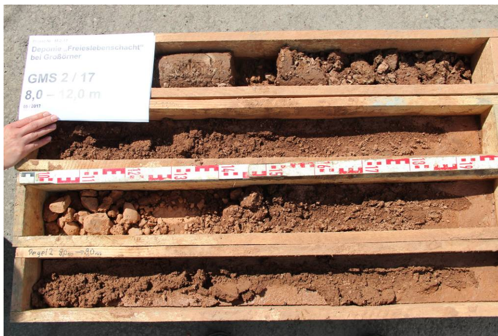
Abbildung 7: Bohrung GWM 2, t = 8,0 – 12,0 m unter GOK
