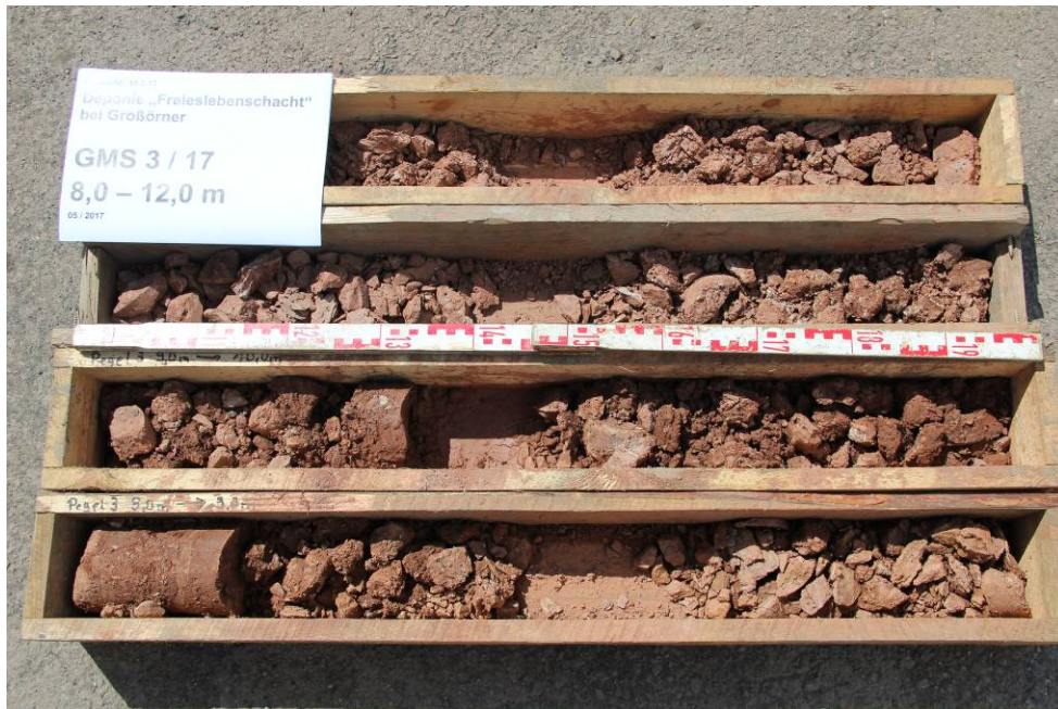
Abbildung 11: Bohrung GWM 3, t = 8,0 – 12,0 m unter GOK
