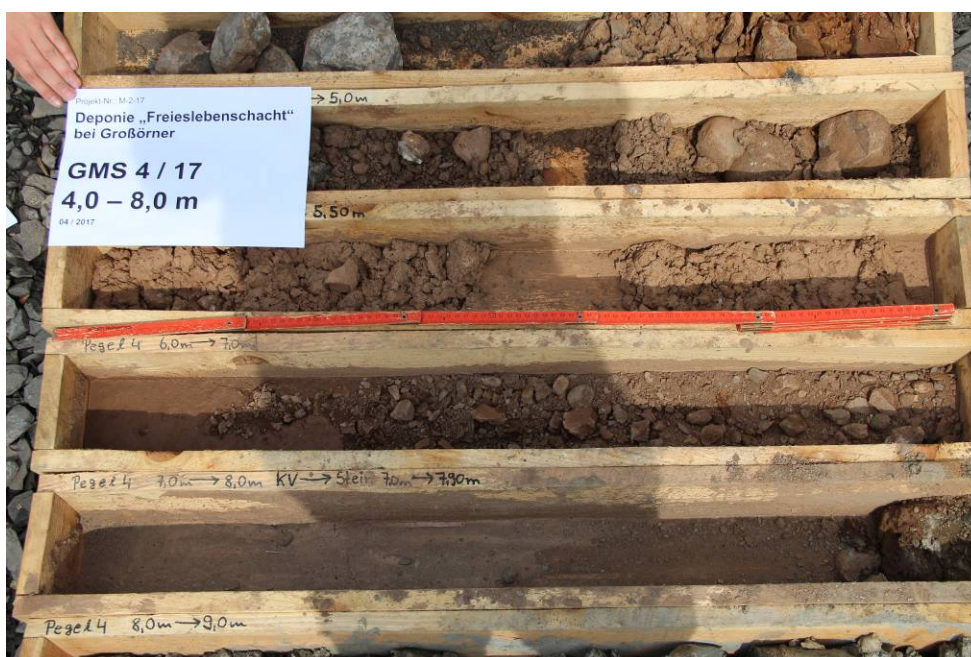
Abbildung 14: Bohrung GWM 4, t = 4,0 – 8,0 m unter GOK
