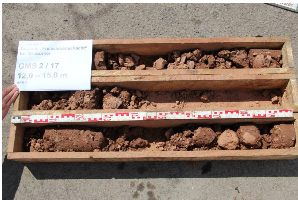
Abbildung 8: Bohrung GWM 2, t = 12,0 – 15,0 m unter GOK
