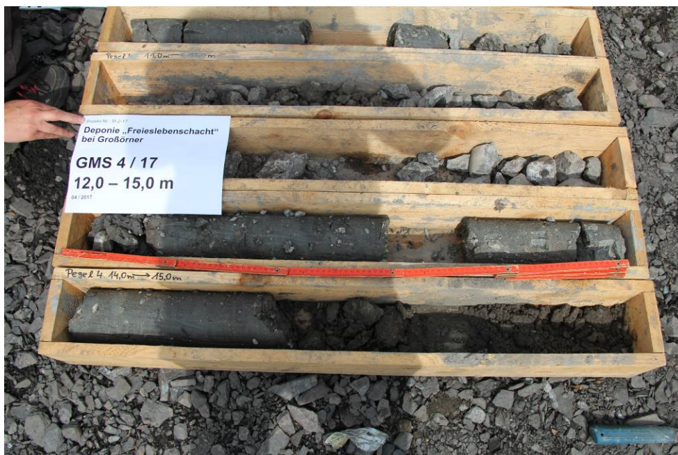
Abbildung 16: Bohrung GWM 4, t = 12,0 – 15,0 m unter GOK
