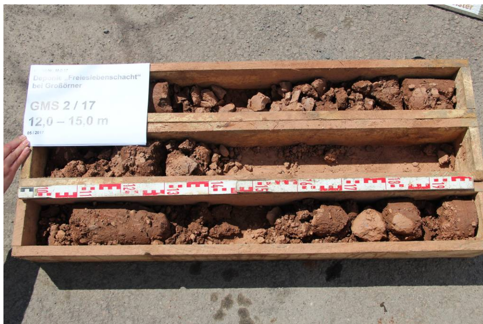
Abbildung 8: Bohrung GWM 2, t = 12,0 – 15,0 m unter GOK
