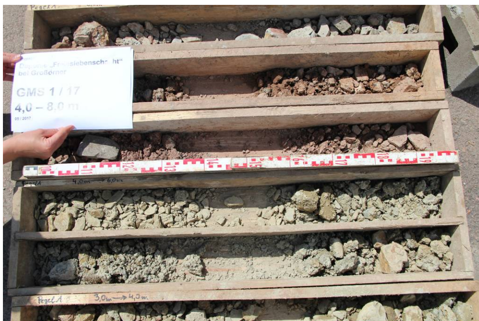
Abbildung 2: Bohrung GWM 1, t = 4,0 – 8,0 m unter GOK
