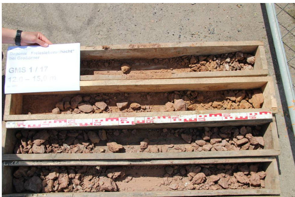
Abbildung 4: Bohrung GWM 1, t = 12,0 – 15,0 m unter GOK
