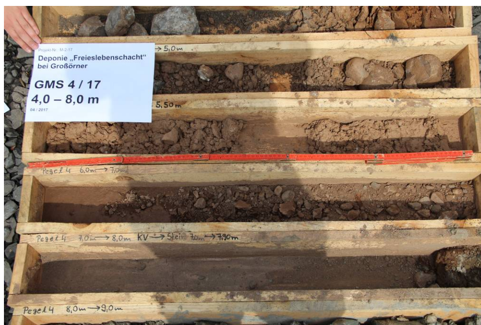
Abbildung 14: Bohrung GWM 4, t = 4,0 – 8,0 m unter GOK
