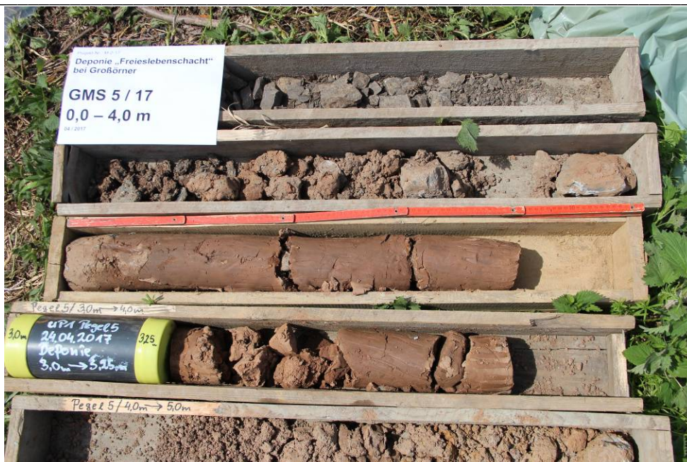
Abbildung 17: Bohrung GWM 5, t = 0 – 4,0 m unter GOK
