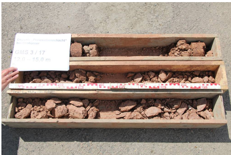
Abbildung 12: Bohrung GWM 3, t = 12,0 – 15,0 m unter GOK
