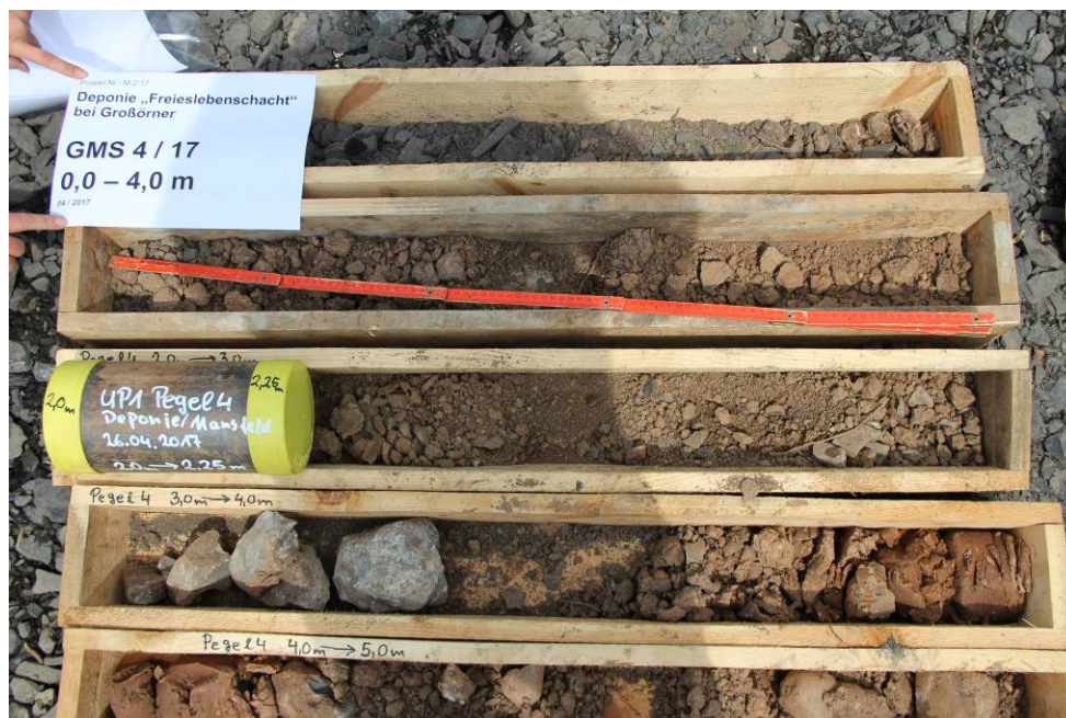
Abbildung 13: Bohrung GWM 4, t = 0 – 4,0 m unter GOK
