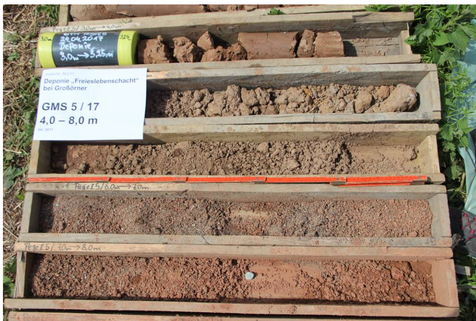
Abbildung 18: Bohrung GWM 5, t = 4,0 – 8,0 m unter GOK
