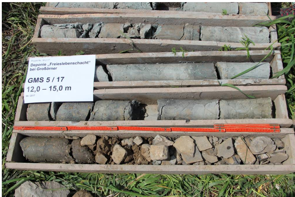
Abbildung 20: Bohrung GWM 5, t = 12,0 – 15,0 m unter GOK
