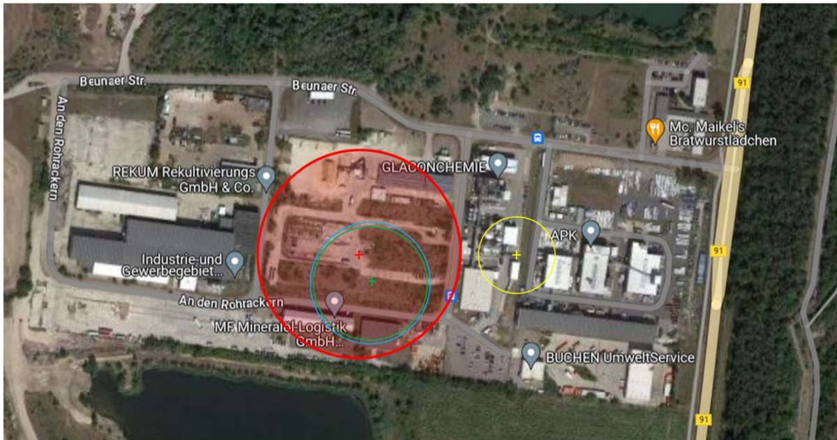
Abbildung 6: Graphische Darstellung des angemessenen Sicherheitsabstandes (Wasserstoff Explosion - rot) sowie der maximalen Distanzen bis zur Unterschreitung der Beurteilungswerte (MIBK Ausbreitung – blau, MIBK Lachenbrand -grün, Methanol Ausbreitung-gelb).
