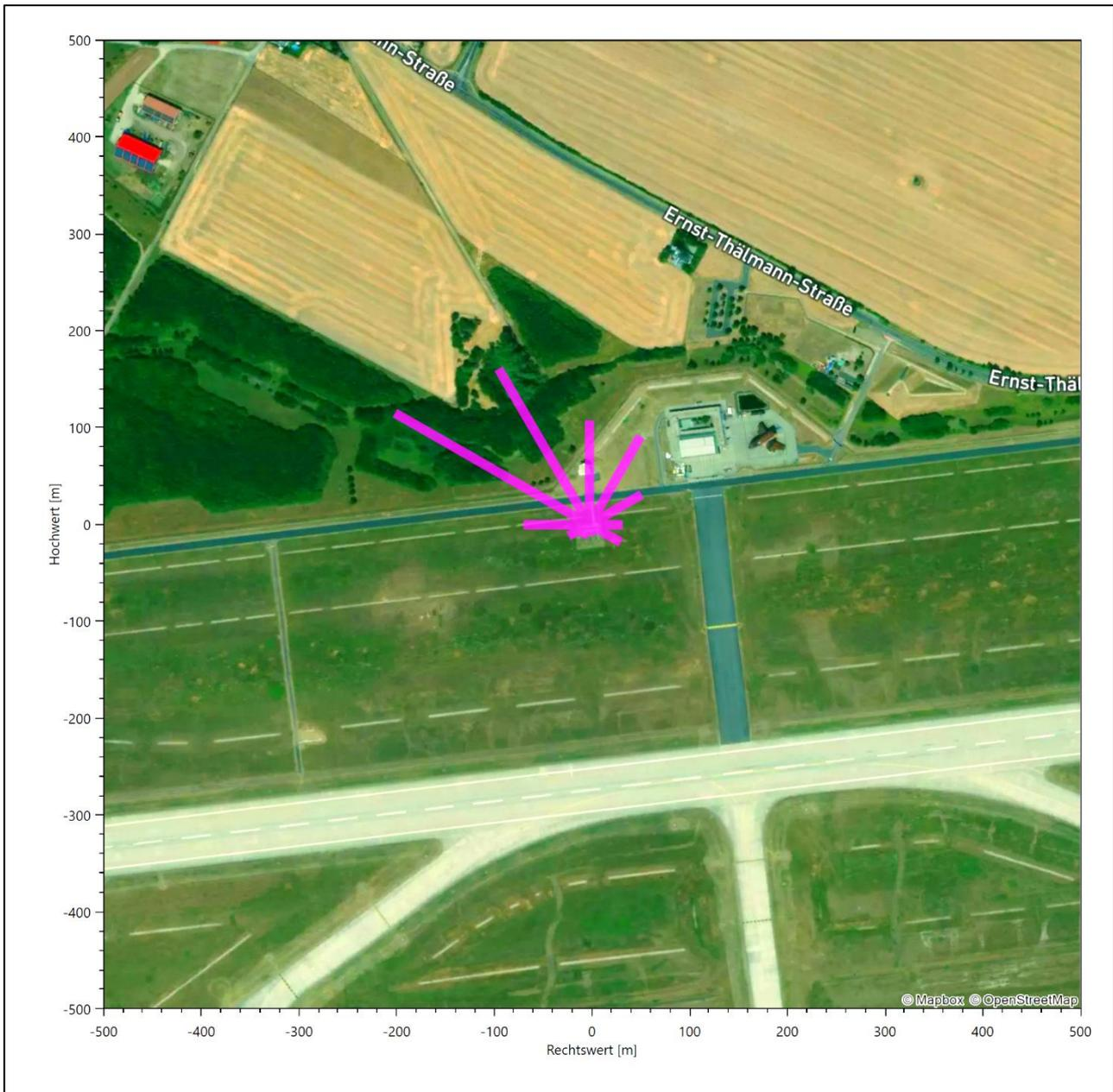
**Abbildung 31: Verteilung der effektiven aerodynamischen Rauigkeiten auf die Windrichtungssektoren für die Station Leipzig/Halle**
