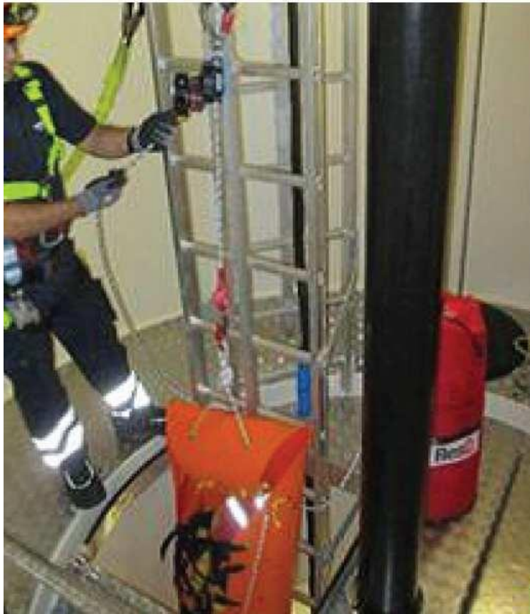
Abbildung 5.25: Absenken der verletzten Person mithilfe der Abstiegsvorrichtung
