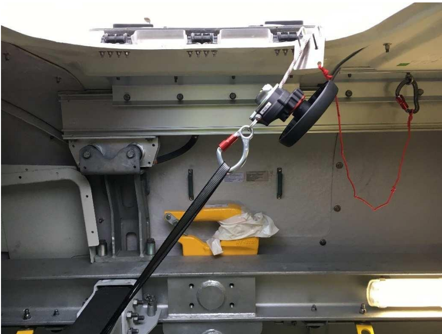
Abbildung 5.16: Abstiegsvorrichtung und Schlinge um den Querträger
