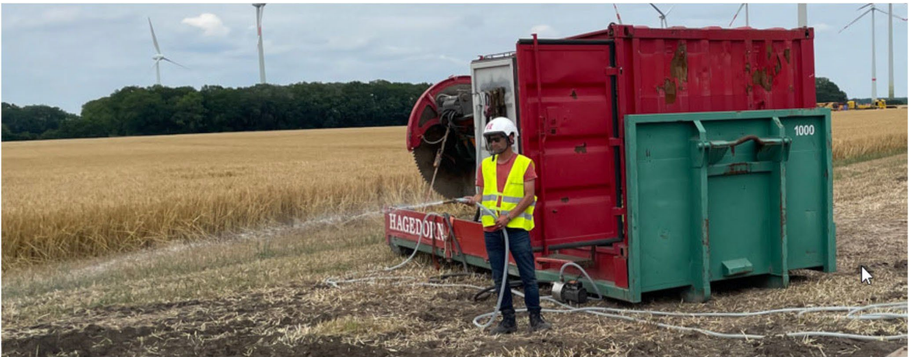
Abbildung 5 exemplarische Darstellung Schneideplateau mit Wassertank und Pumpe
