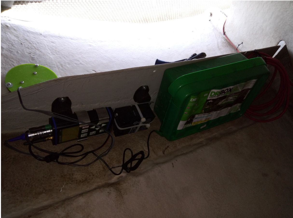
Abbildung 12: Vergitterte Öffnung am Gondelende bei den Windworld-Anlagen. Im Vordergrund das installierte Batcorder-System.
