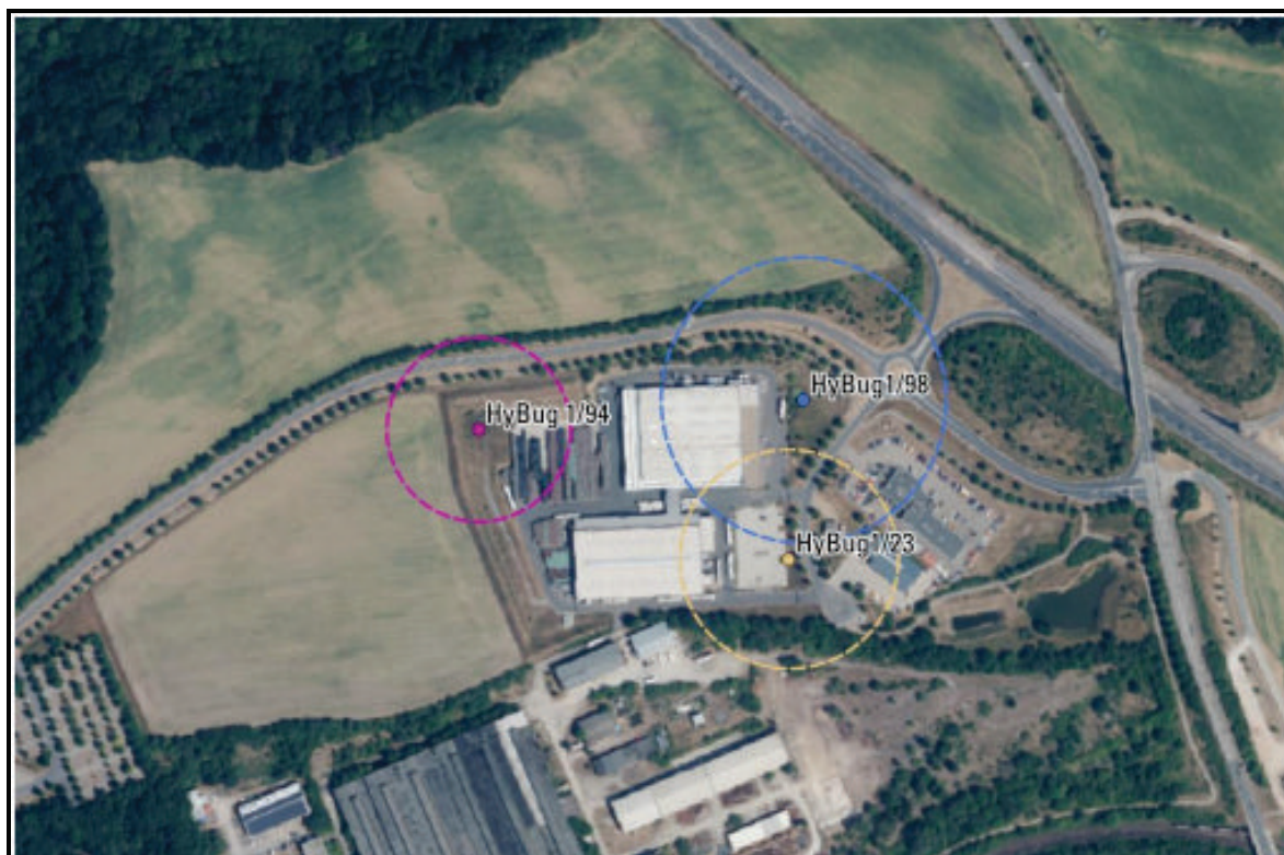
Abb. 1: Detailkarte der vorhandenen Brunnen und ihrer Absenktrichter
