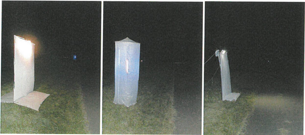
Abb. 3: verwendete Lichtquellen unmittelbar nach dem Einschalten gegen 21:00 Uhr (links: Mischlicht 160 W, Mitte: Schwarzlicht 15 W, rechts LED-Leuchte 35 W)
