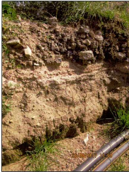
Abbildung 12: Bodenaufschluss am Beginn der Ausbaustrecke (Erdarbeiten nahe ARAL-Tankstelle). Boden aus Flugsand, Schotter im Oberboden aus Straßenuntergrund
