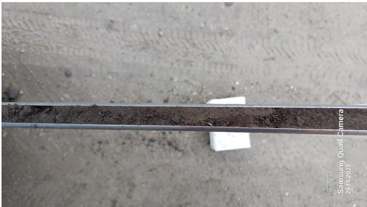
Abbildung 17: A xh -Horizont mit < 0,6m Mächtigkeit bei Bohrung Nr. 12 / 29.11.2022
