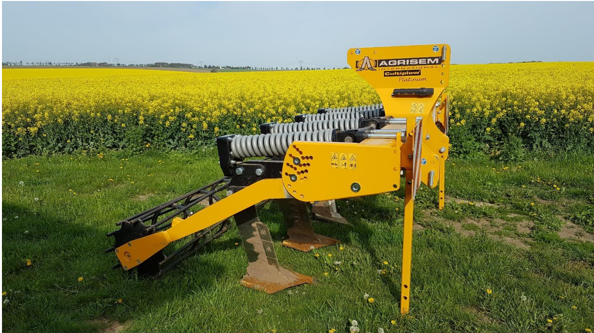
Abbildung 19: Beispiel eines sehr gut geeigneten landwirtschaftlichen Tiefenlockerers.
