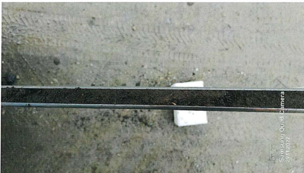
Abbildung 17: Axh-Horizont mit < 0,6m Mächtigkeit bei Bohrung Nr. 12 / 29.11.2022
