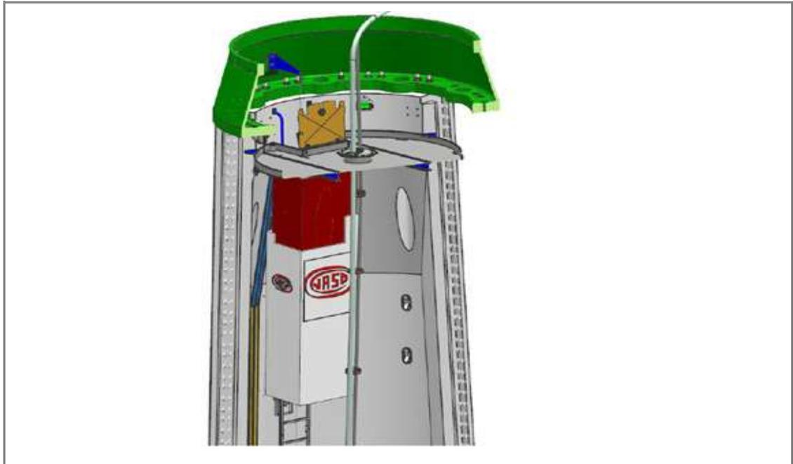
Abb. 3: JASO-Hebebühne für Beton- und Hybridturm (TC100N und TC168N)
