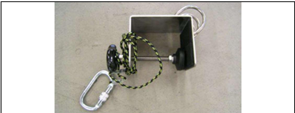
Abb. 26: U-förmiger Kantenschutz
