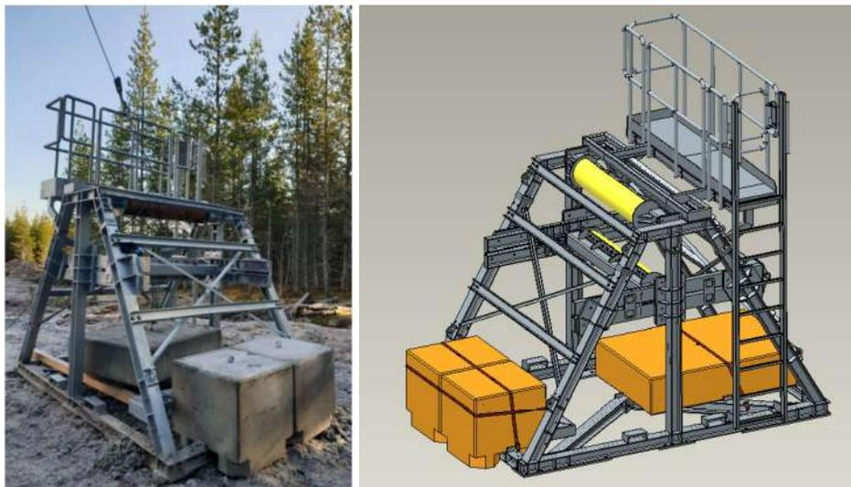
Abbildung 39 Darstellung eines Gestells für die Reibseilabspannung
