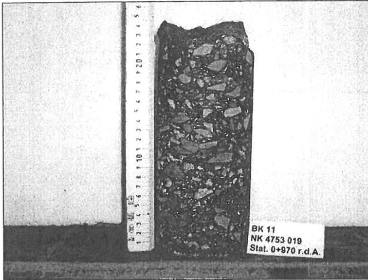
Fahrbahnoberkante im Foto an der Unterseite des Bohrkerns (Bohrkern steht auf dem Kopf!)
