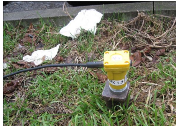
Abb. 19 Messaufnehmer in 124 m Abstand zum nächstgelegenen Gleis (MP 3z Boden)
