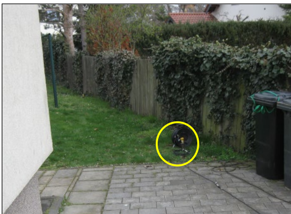
Abb. 14 Messaufnehmer in 32 m Abstand zum nächstgelegenen Gleis (MP 3z Boden)
