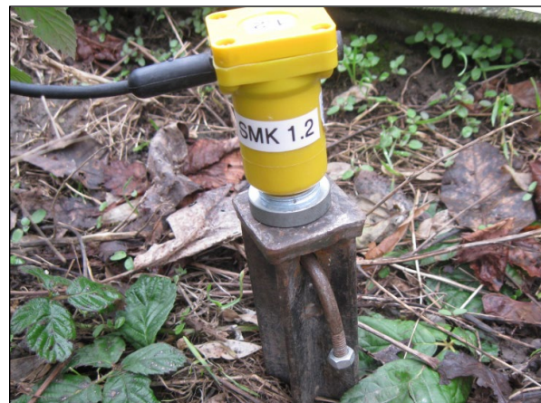
Abb. 18 Messaufnehmer in 16 m Abstand zum nächstgelegenen Gleis (MP 2z Boden)
