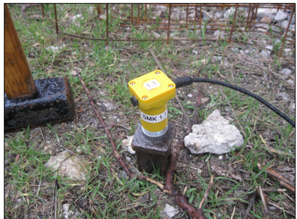
Abb. 5 Messaufnehmer am Emissionsmesspunkt in 8 m Abstand zum Gleis (MP 4z Boden)
