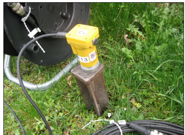
Abb. 14 Messaufnehmer in 32 m Abstand zum nächstgelegenen Gleis (MP 3z Boden)
