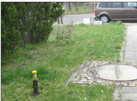
Abb. 13 Messaufnehmer in 16 m Abstand zum nächstgelegenen Gleis (MP 2z Boden)
