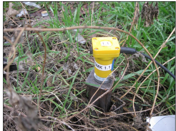
Abb. 17 Messaufnehmer in 8 m Abstand zum nächstgelegenen Gleis (MP 1z Boden)
