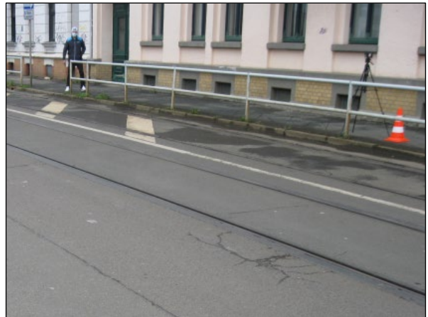
Abb. 10 Messaufnehmer am Emissionsmesspunkt in 3,5 m Abstand zum Gleis (MP 4z Fußweg) und Straßenoberfläche mit Lichtschranken-Standort
