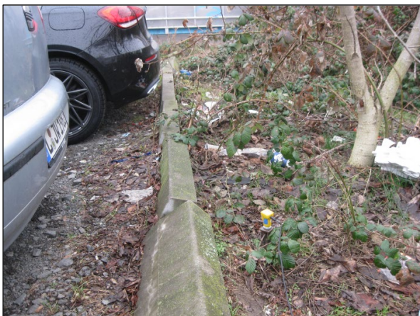
Abb. 18 Messaufnehmer in 16 m Abstand zum nächstgelegenen Gleis (MP 2z Boden)
