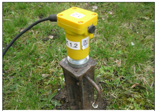
Abb. 13 Messaufnehmer in 16 m Abstand zum nächstgelegenen Gleis (MP 2z Boden)
