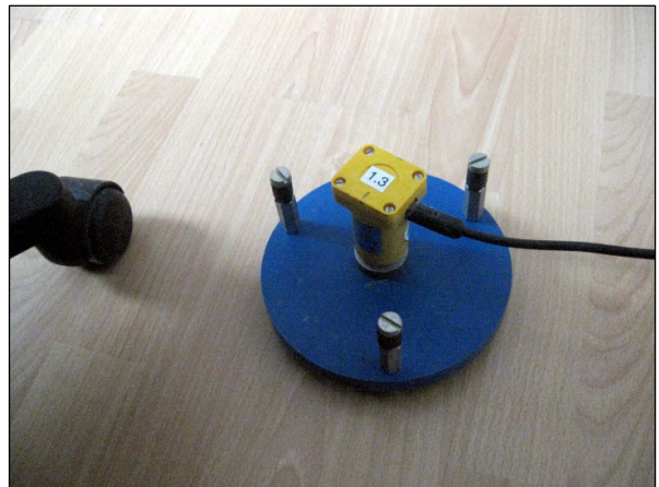
Abb. 4 Messaufnehmer im 4. Obergeschoss (Wohnzimmer straßenseitig li., MP 3z Gebäude)
