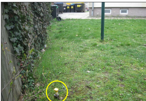
Abb. 15 Messaufnehmer in 40 m Abstand zum nächstgelegenen Gleis (MP 4z Boden)
