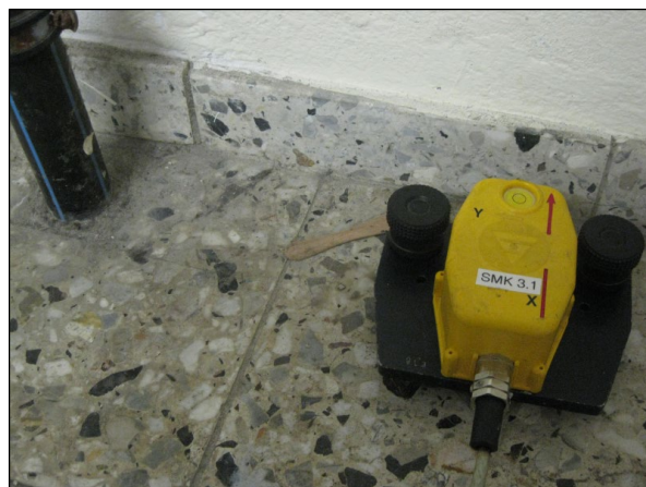
Abb. 2 Messaufnehmer am Gebäudefundament (Keller straßenseitig, MP 1 x/y/z Gebäude)
