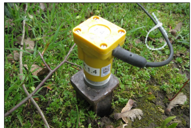
Abb. 15 Messaufnehmer in 40 m Abstand zum nächstgelegenen Gleis (MP 4z Boden)
