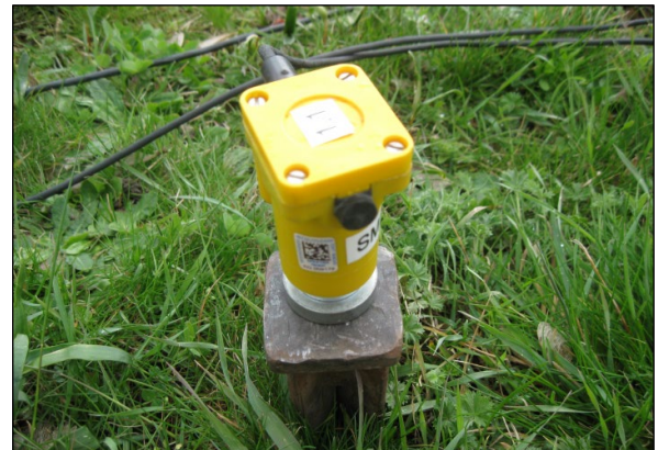
Abb. 12 Messaufnehmer 8 m Abstand zum nächstgelegenen Gleis (MP 1z Boden)
