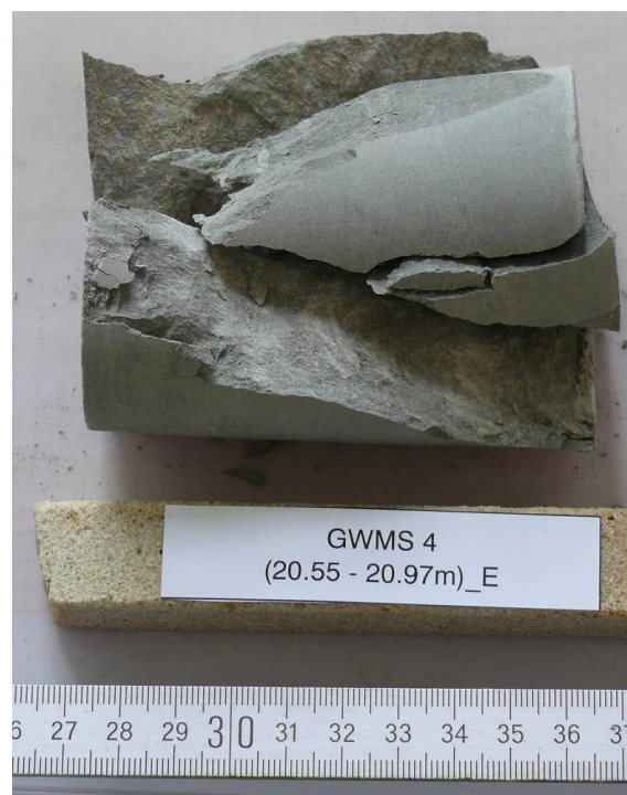
Abb. 12: GWMS 4 (20.55-20.93m)_E, Einaxialer Druckversuch, Bruchbild, Scherbruch
