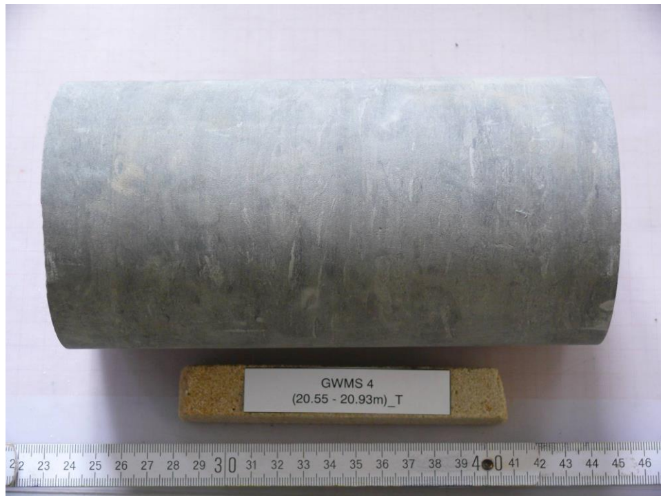
Abb. 21: GWMS 4 (20.55-20.93m)_T, Prüfkörper vor dem Versuch
