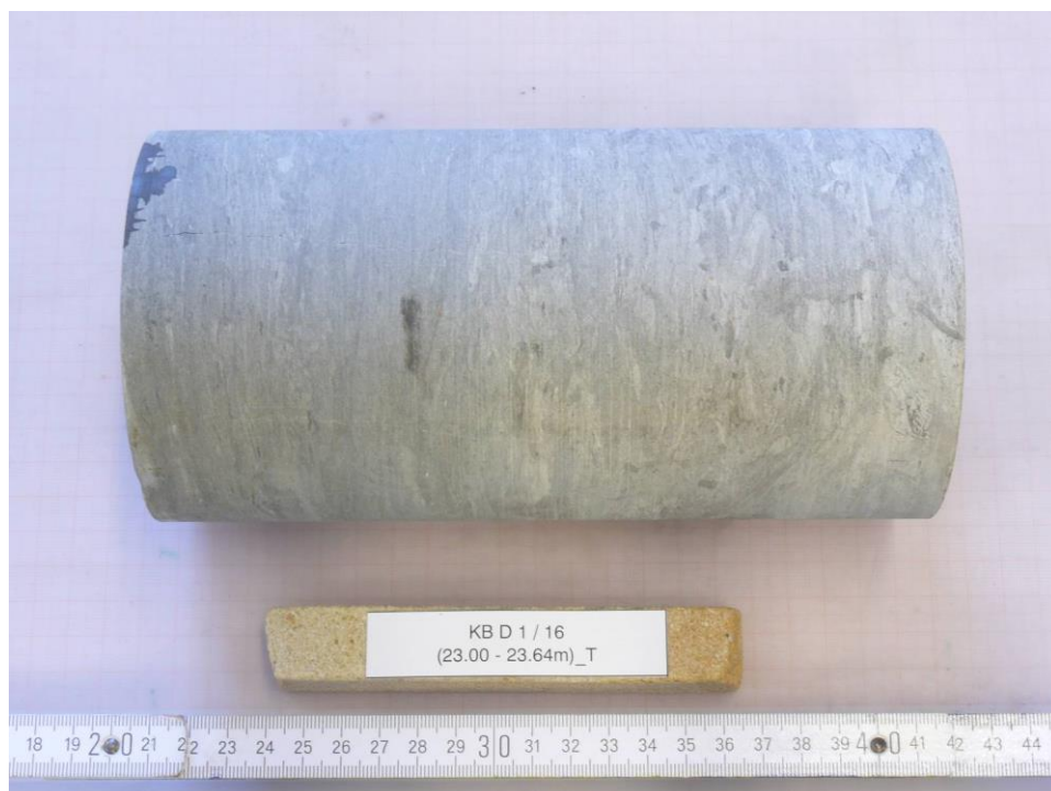
Abb. 20: KB D 1/16 (23.00-23.64m)_T, Triaxialer Druckversuch, Bruchbild
