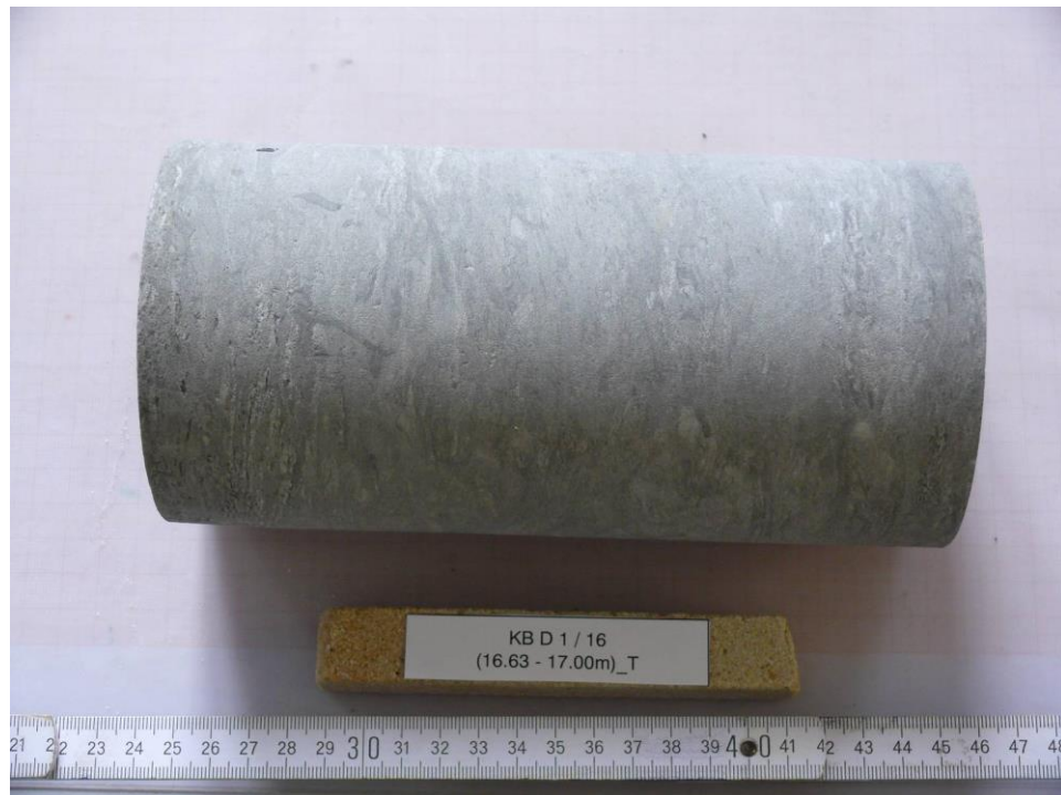
Abb. 17: KB D 1/16 (16.63-17.00m)_T, Prüfkörper vor dem Versuch
