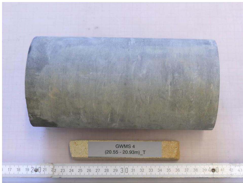
Abb. 22: GWMS 4 (20.55-20.93m)_T, Triaxialer Druckversuch, Bruchbild
