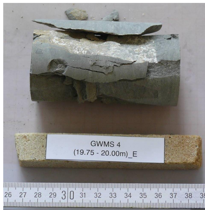
Abb. 10: GWMS 4 (19.75-20.00m)_E, Einaxialer Druckversuch, Bruchbild, Spaltbruch überwiegend
