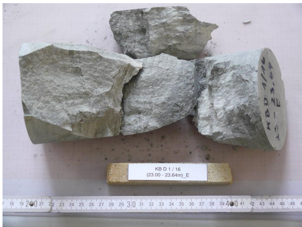
Abb. 6: KB D 1/16 (23.00-23.64m)_E, Einaxialer Druckversuch, Bruchbild, Scherbruch
