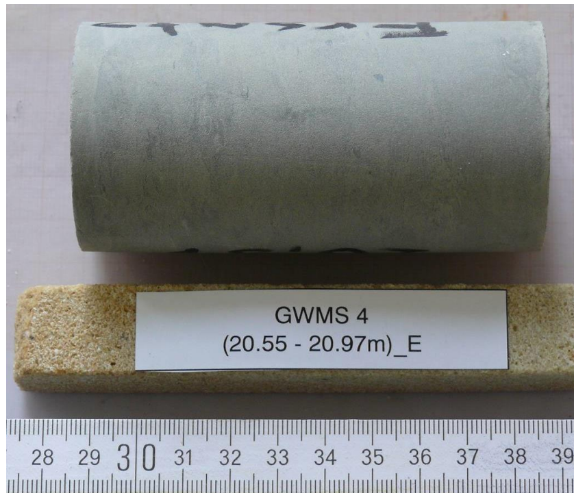
Abb. 11: GWMS 4 (20.55-20.93m)_E, Prüfkörper vor dem Versuch
