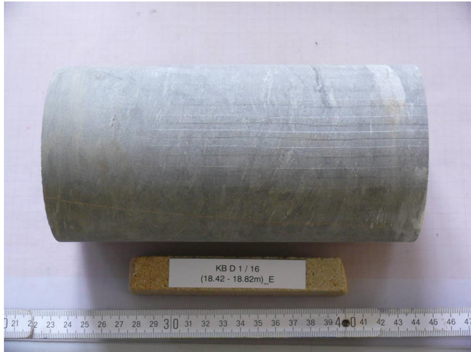
Abb. 3: KB D 1/16 (18.42-18.82m)_E, Prüfkörper vor dem Versuch
