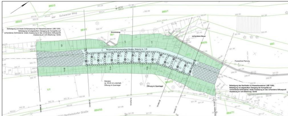
Abb. 3: Rückbaumaßnahme der Sohlschwelle Ö2 im Wasserflächenumfang von 394 m<sup>2</sup> (ICL)
