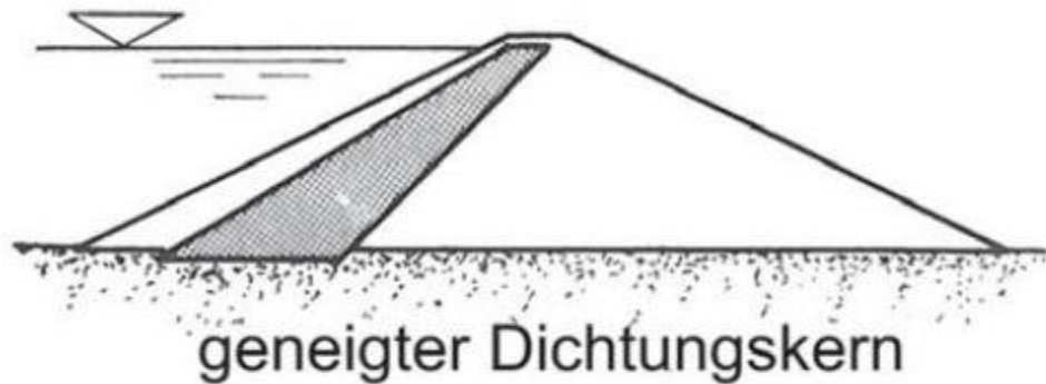
Abb. 15: Damm mit geneigter Innendichtung
