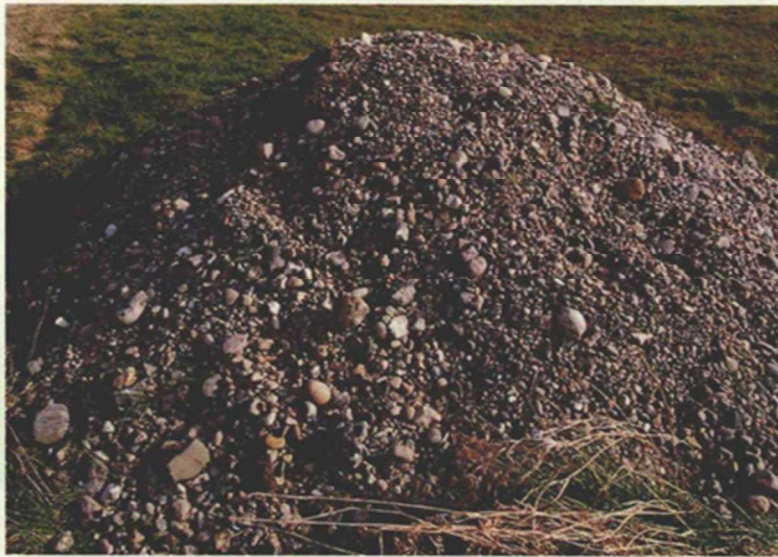
Abbildung 1: Kiessubstrat zum Einbau in der Gewässersohle
