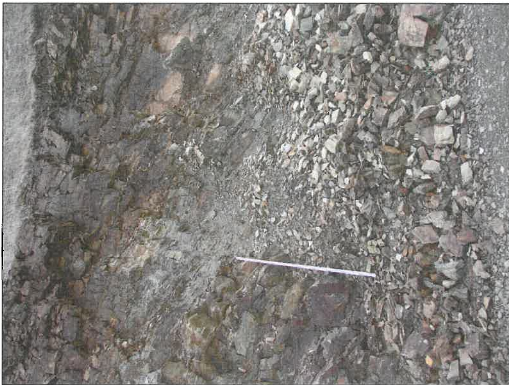
Bild 19: 1. Sohle mit kleinstückigem Zerfall der Metagrauwacke
