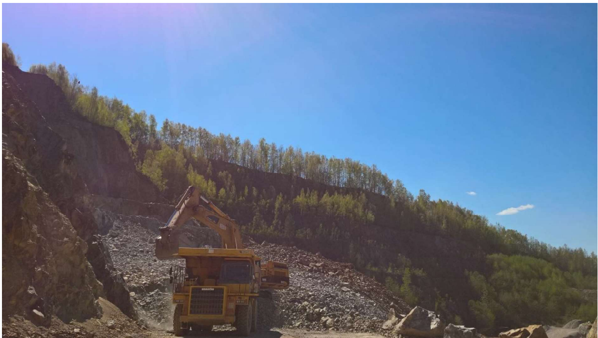
Beladung eines Kippers mit Bagger, Umwallung und Bepflanzung im Hintergrund
