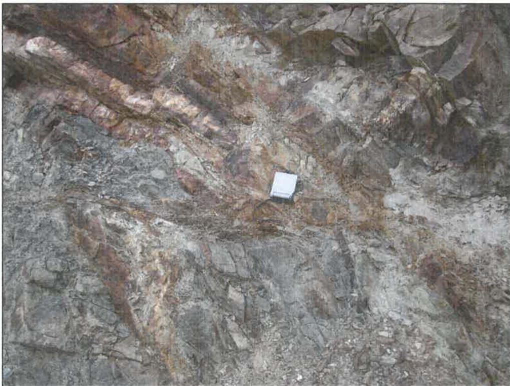
Bild 2: gefaltete Metagrauwacke mit Quarzbändern auf der 1. Sohle und Trennflächenabständen im cm-Bereich
