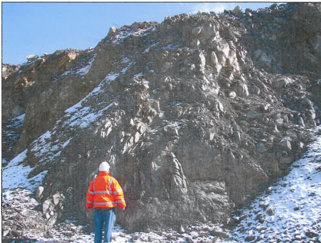
Bild 14: quer durch den Tagebau verlaufende Störungszone mit einer Breite bis \geq 20 m und bindigem Zersatz
