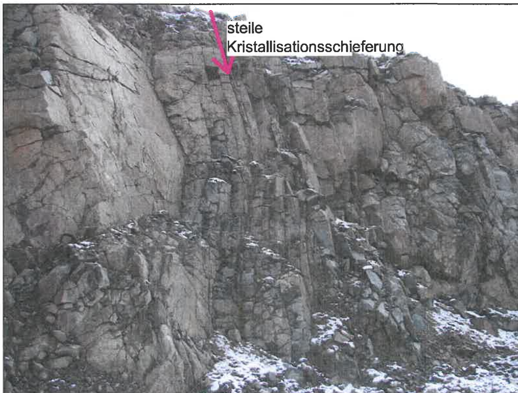
Bild 8: steile Kristallisationsschieferung im Muskovitgneis auf der 5. Sohle
