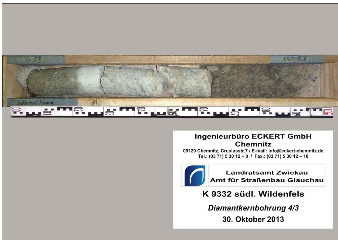
Profil 4 / Diamantkernbohrung (DKB) 4/3 – Ansicht Bohrkern
