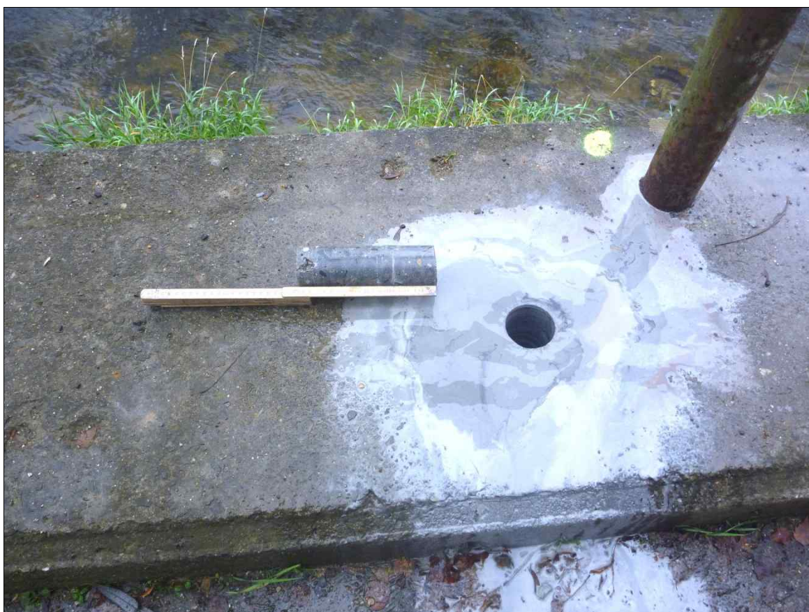
Probe Kappenbeton (P) 2 – Ansicht Bohrkern
