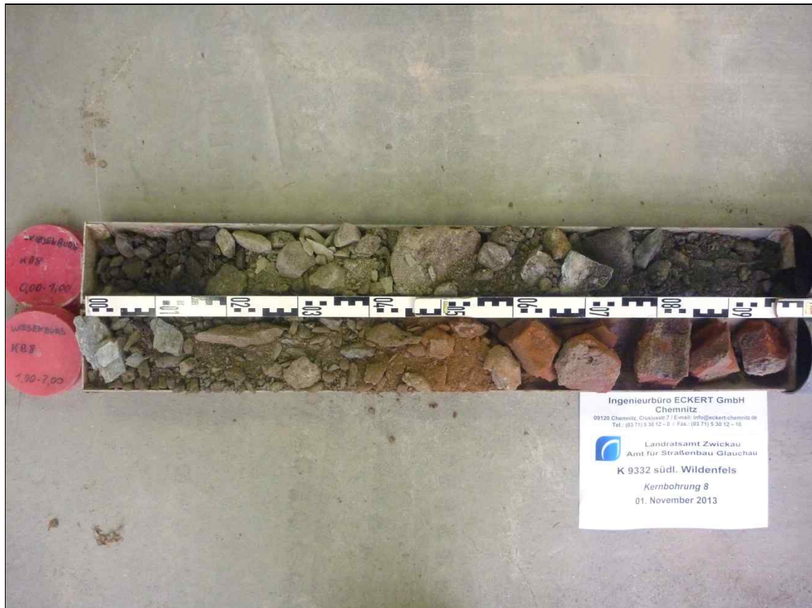
Rotationskernbohrung (KB) 8 – Ansicht Bohrkern
