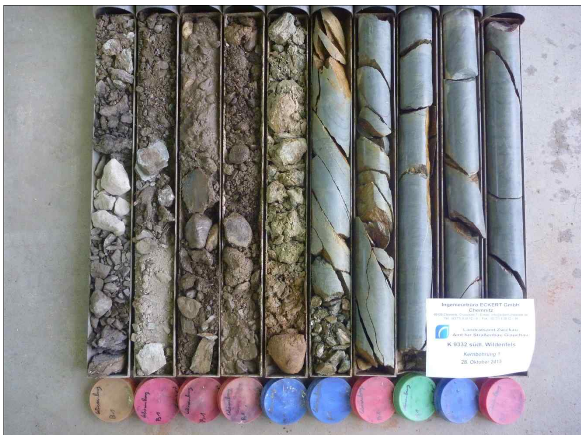
Rotationskernbohrung (KB) 1 – Ansicht Bohrkern
