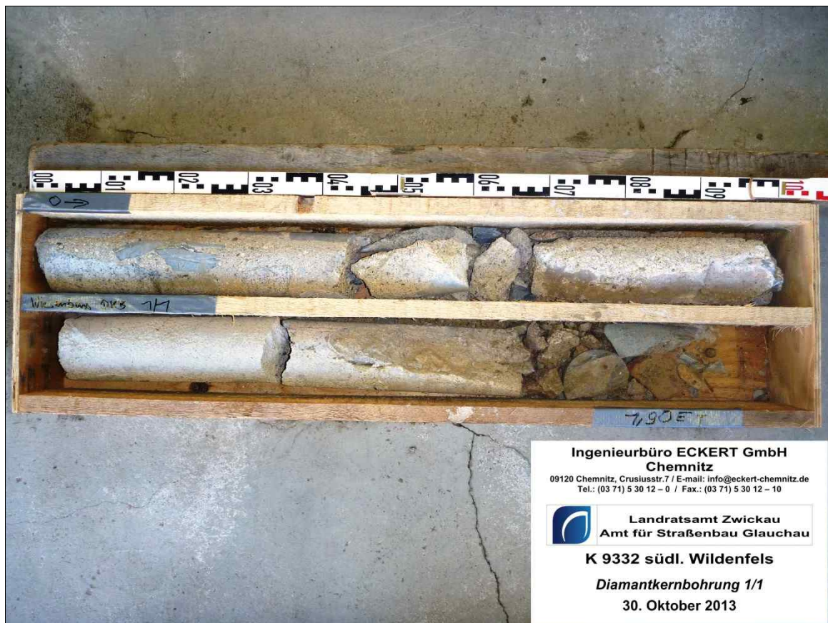
Profil 1 / Diamantkernbohrung (DKB) 1/1 – Ansicht Bohrkern
