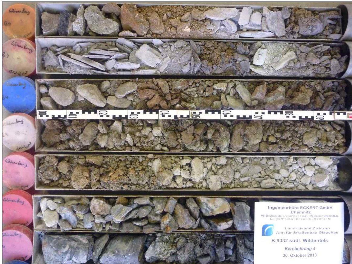
Rotationskernbohrung (KB) 4 – Ansicht Bohrkern
