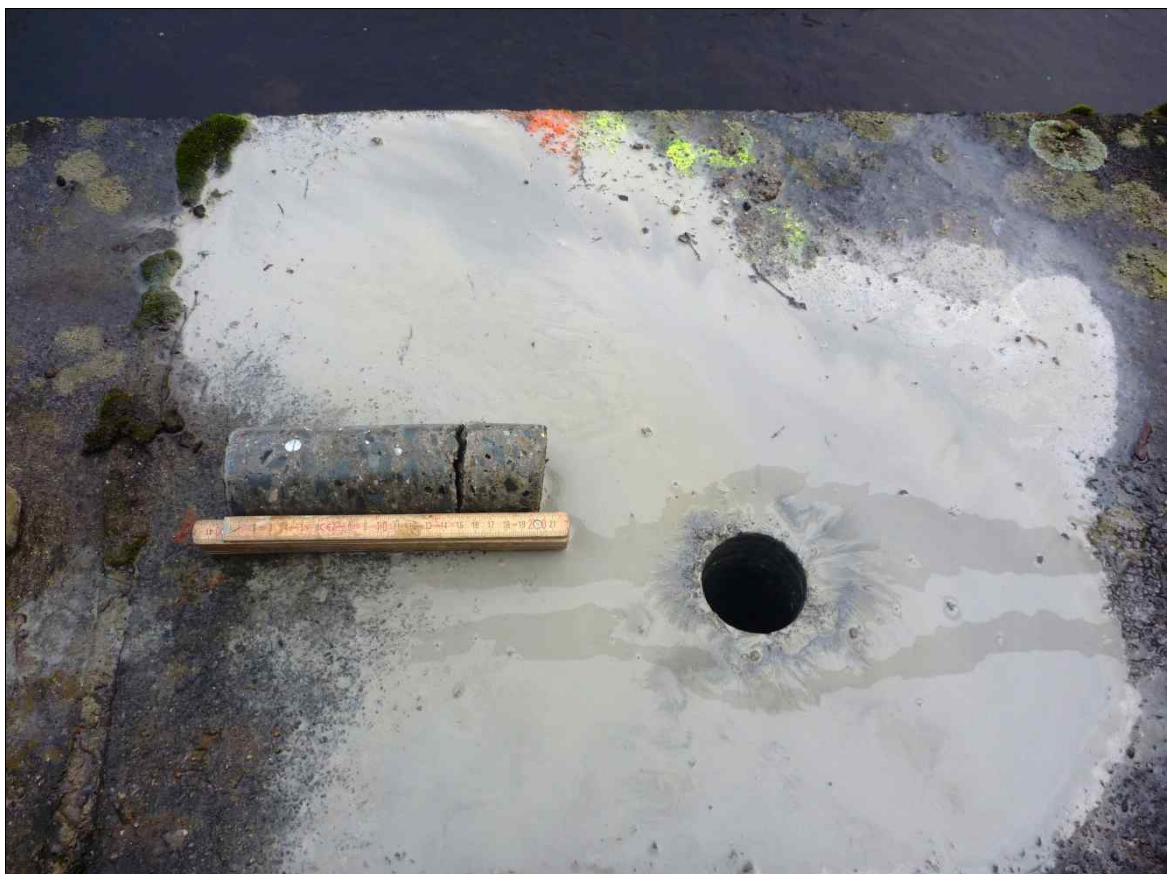
Probe Kappenbeton (P) 1 – Ansicht Bohrkern
