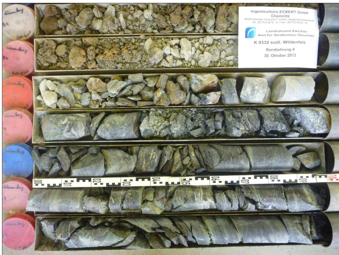
Rotationskernbohrung (KB) 4 – Ansicht Bohrkern
