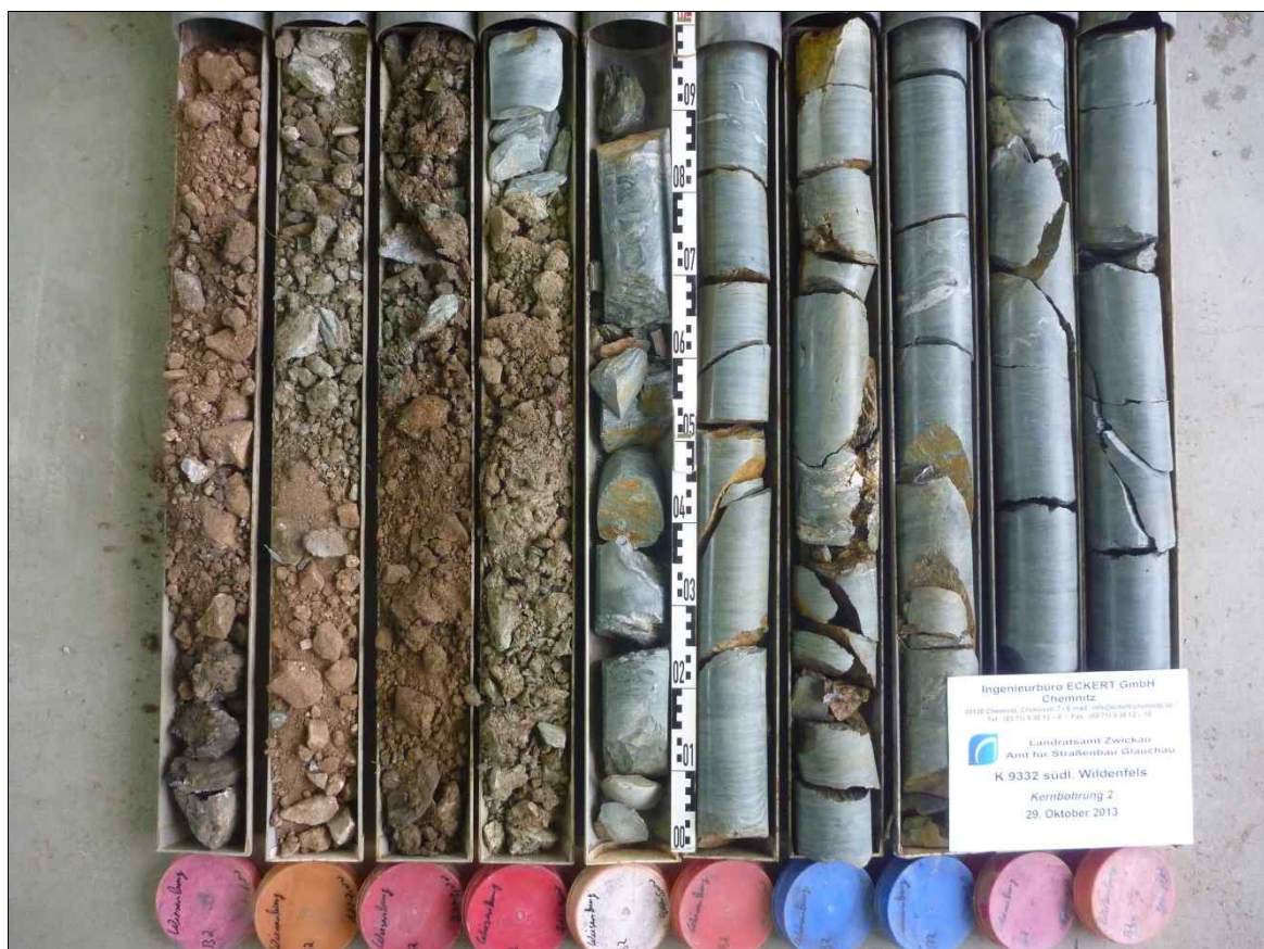
Rotationskernbohrung (KB) 2 – Ansicht Bohrkern
