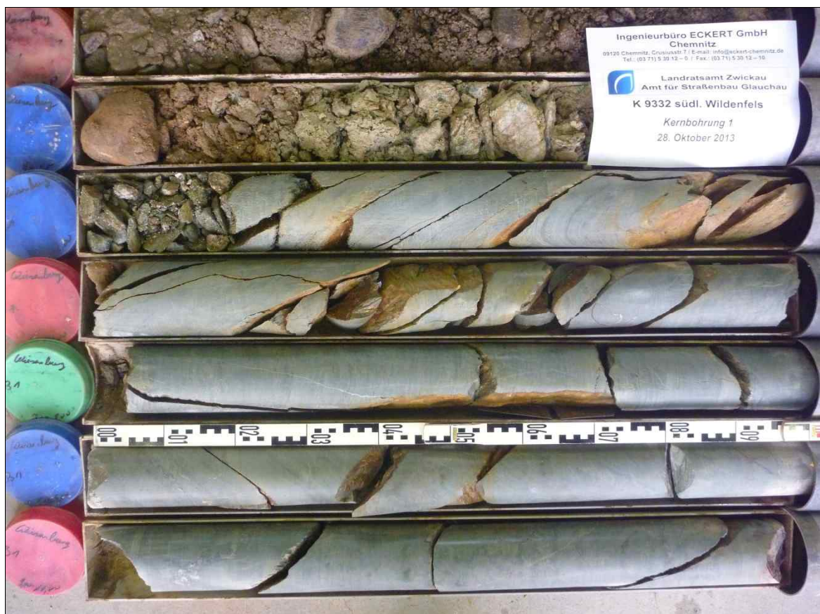
Rotationskernbohrung (KB) 1 – Ansicht Bohrkern
