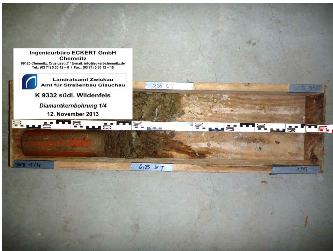
Profil 1 / Diamantkernbohrung (DKB) 1/4 – Ansicht Bohrkern
