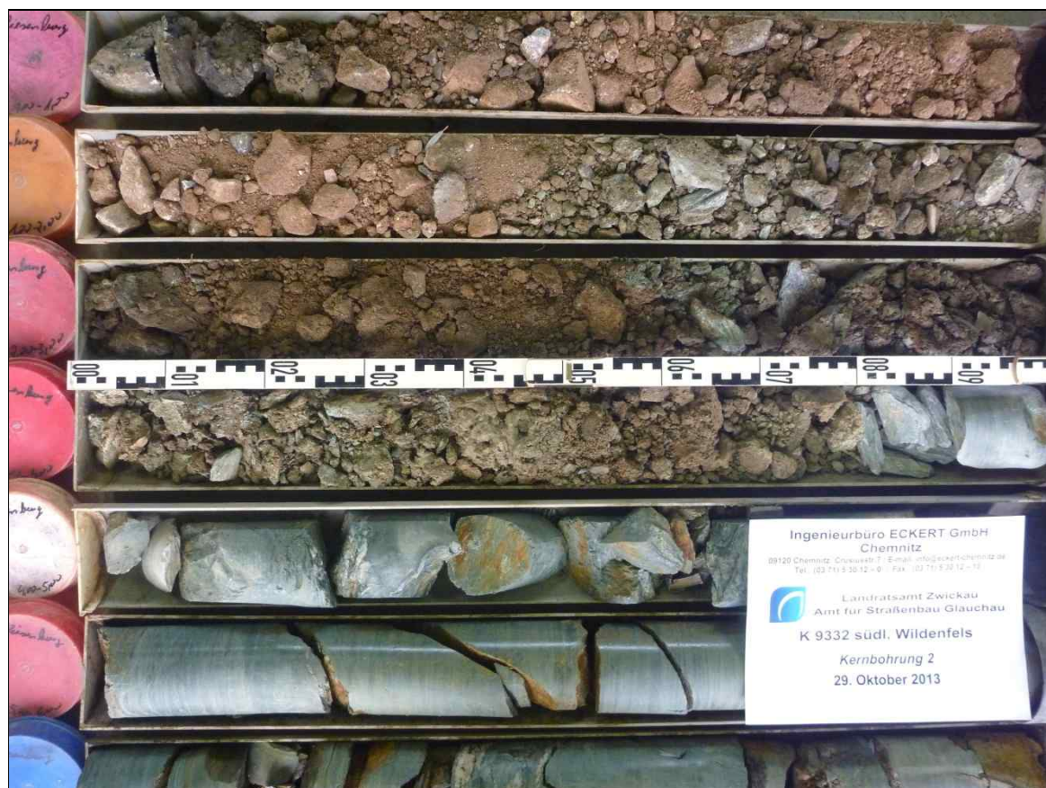
Rotationskernbohrung (KB) 2 – Ansicht Bohrkern
