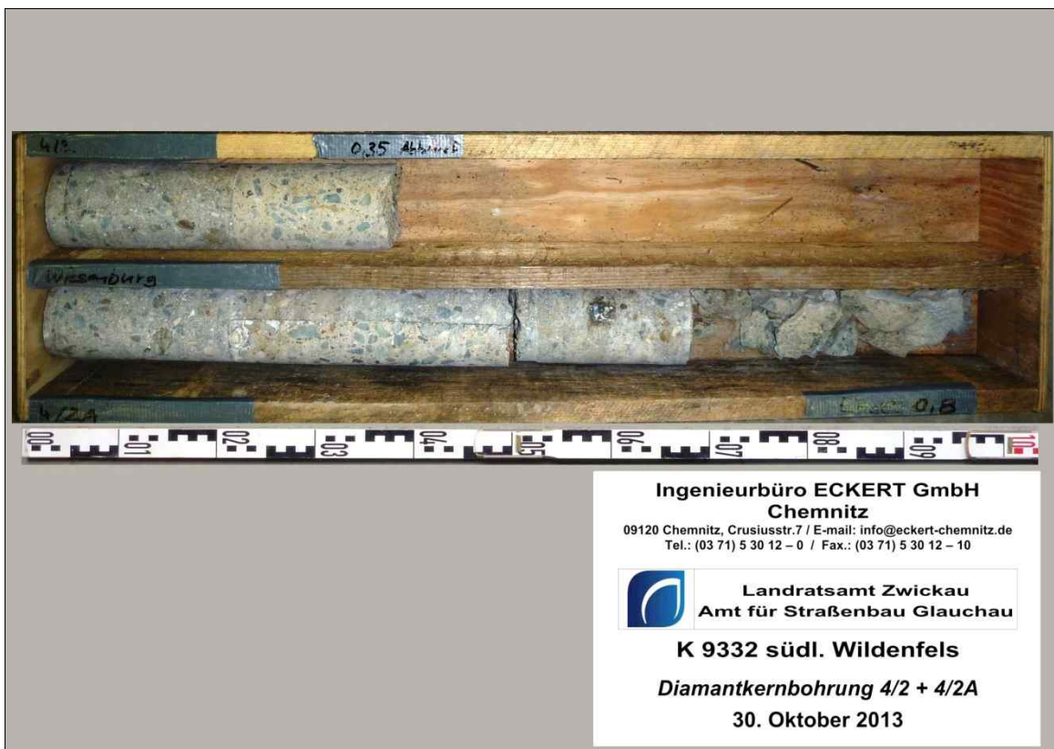
Profil 4 / Diamantkernbohrung (DKB) 4/2 + 4/2A – Ansicht Bohrkern
