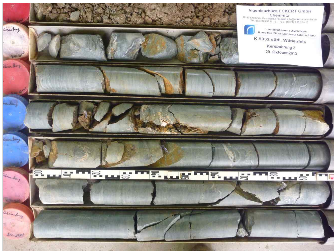
Rotationskernbohrung (KB) 2 – Ansicht Bohrkern
