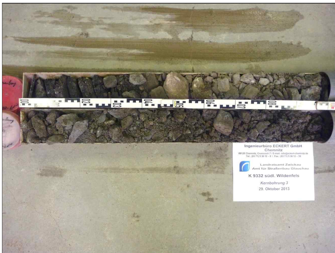
Rotationskernbohrung (KB) 3 – Ansicht Bohrkern
