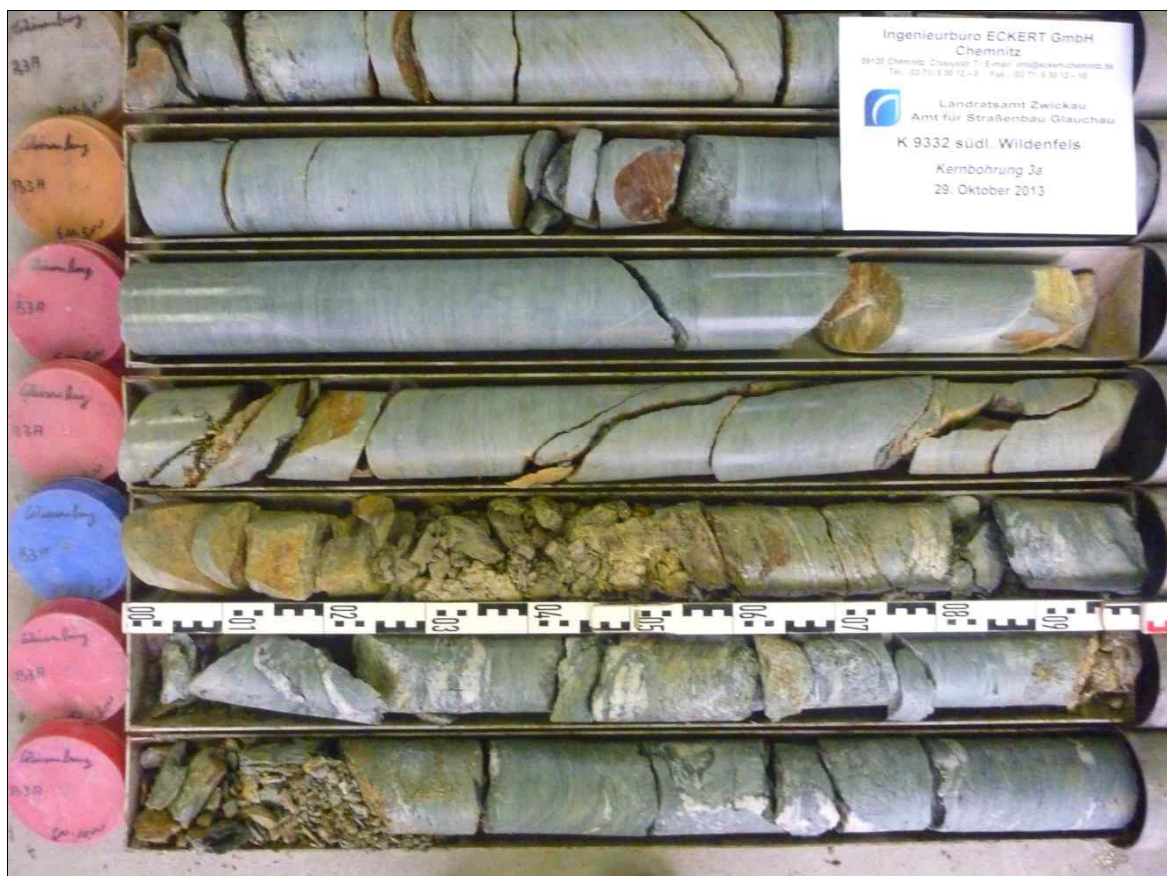
Rotationskernbohrung (KB) 3a – Ansicht Bohrkern
