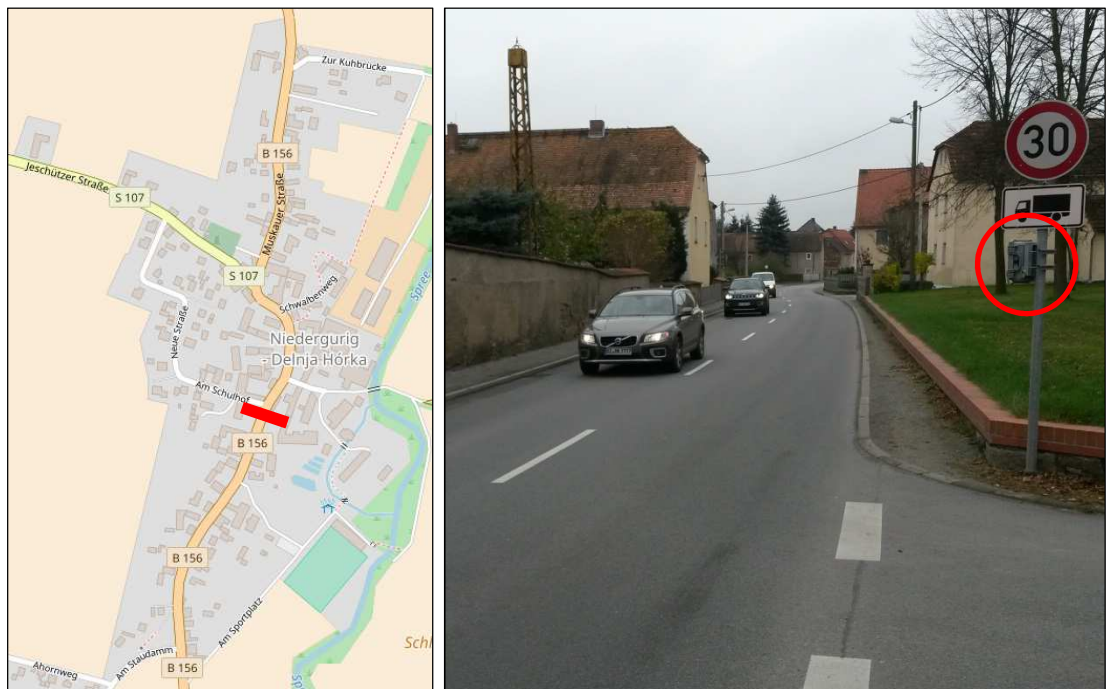
Abbildung 5: Standort Seitenradarmessung Niedergurig (Quelle Hintergrund: ©OpenStreetMap-Mitwirkende)
