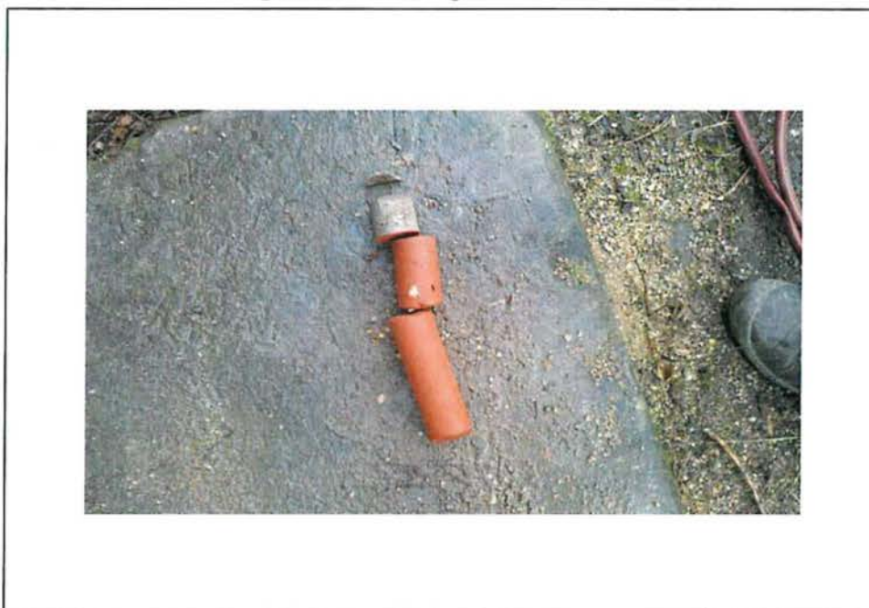
Bohrkern Außenwand Öllager
