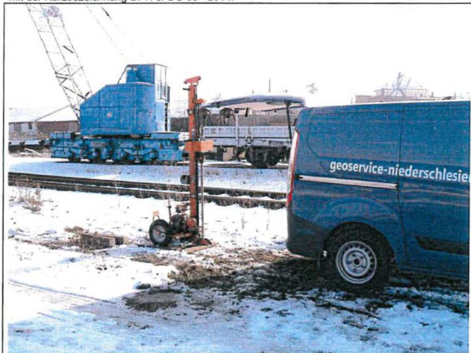
Foto 10: Das Foto vom 31.01.2014 zeigt das Aus-/ Durchführung der DPH 1/ BG 05 - 2014.
