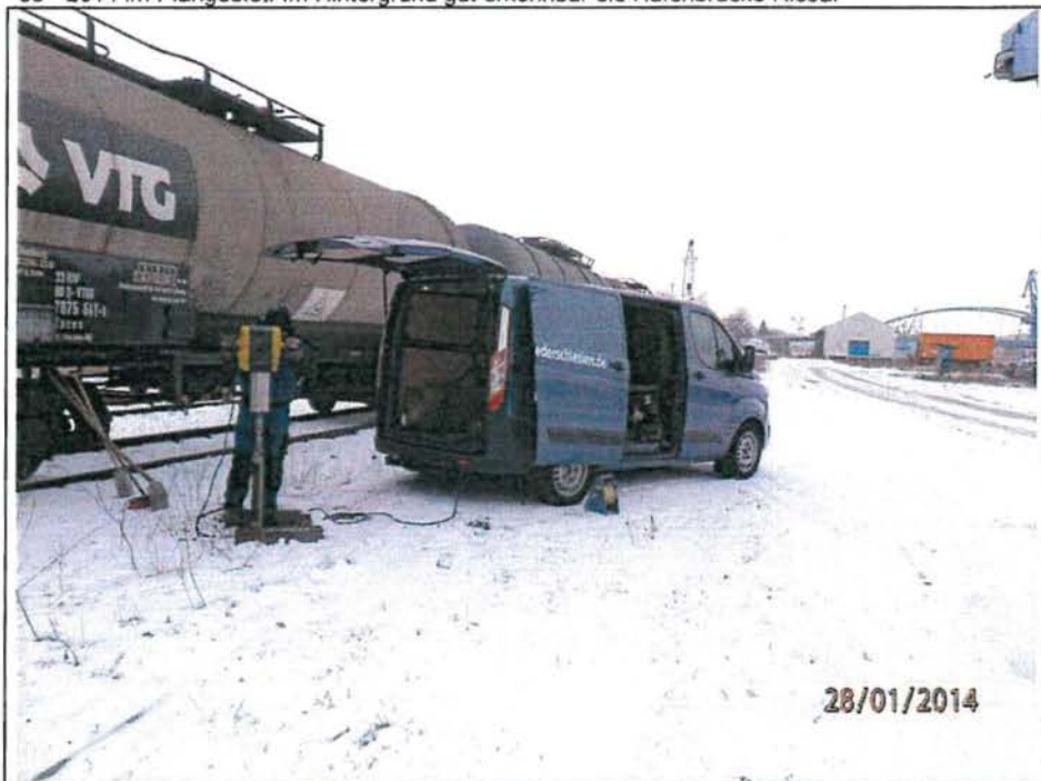
Foto 4: Das Foto vom 28.01.2014 dokumentiert das Abteufen der RKS 6/ BG 05 - 2014.
