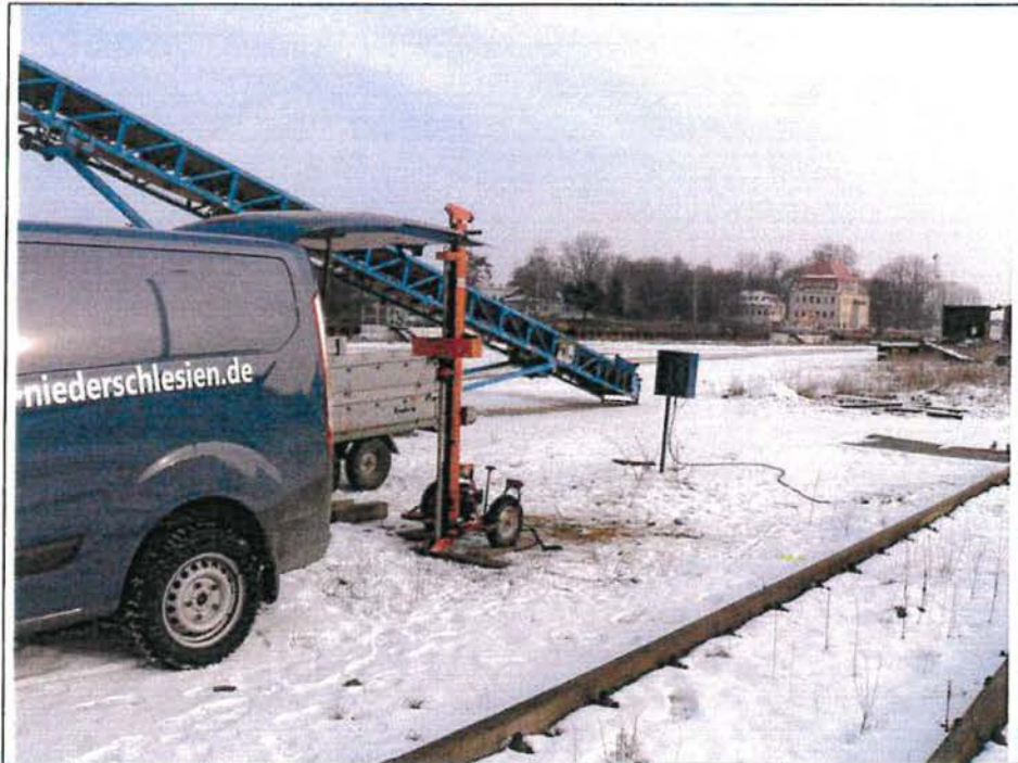
Foto 9: Das Foto vom 31.01.2014 dokumentiert die Aus-/ Durchführung der Schweren Rammsondierung mit der Kurzbezeichnung DPH 3/ BG 05 - 2014.
