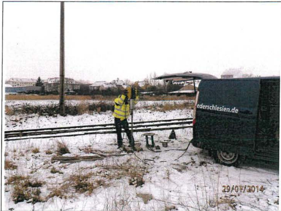
Foto 5: Das Foto vom 29.01.2014 dokumentiert das Abteufen der Rammkernsondierung mit der Kurzbezeichnung RKS 7/ BG 05 - 2014.
