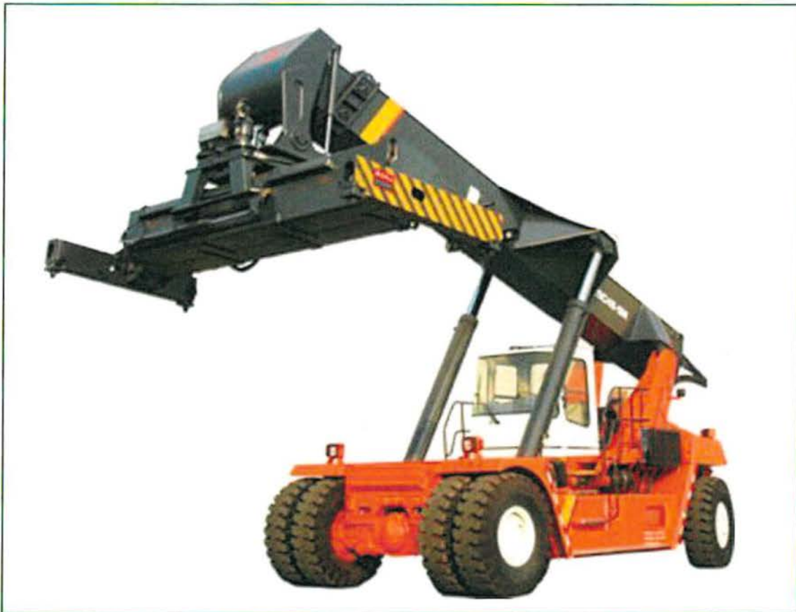
Bild 20: Reachstacker für Containertransportprozesse
