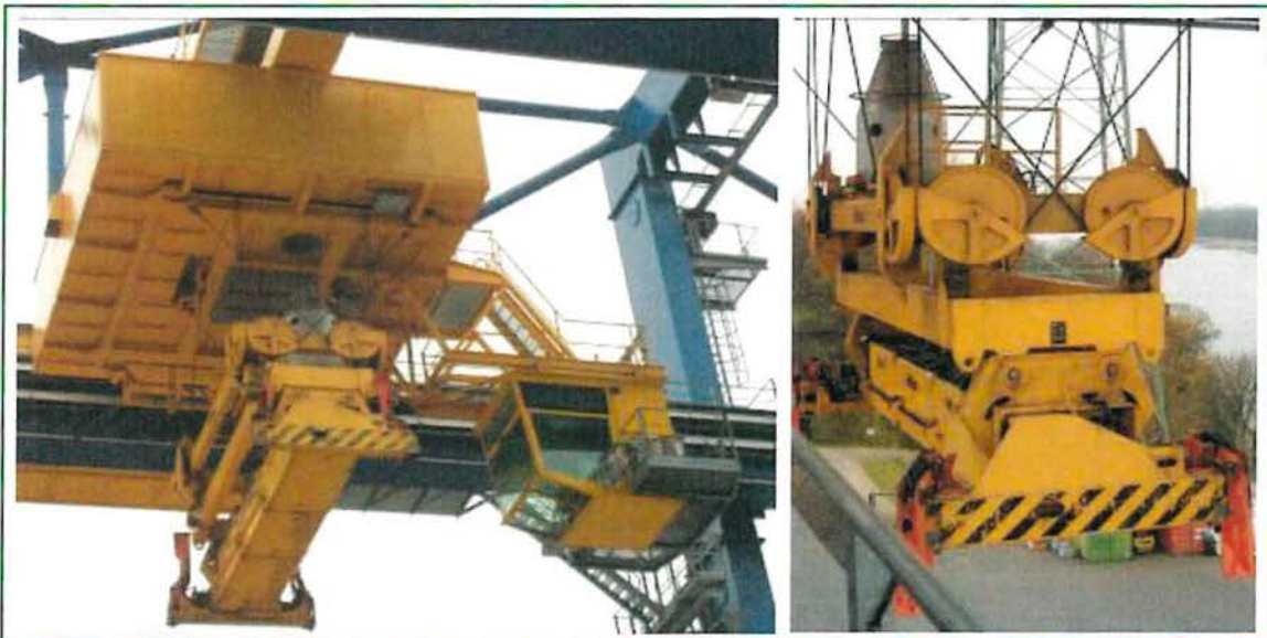
Bild 19: Spreader zur Aufnahme von 20' bis 45'-Containern, Wechsel- u. Jumbobehältern
