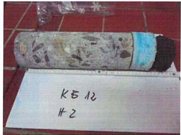
Bohrkern KB 12 (Probe KB 12-1: Beton; Probe KB 12-2 (Auffüllung mit Schlackeanteilen) zu MP 5
