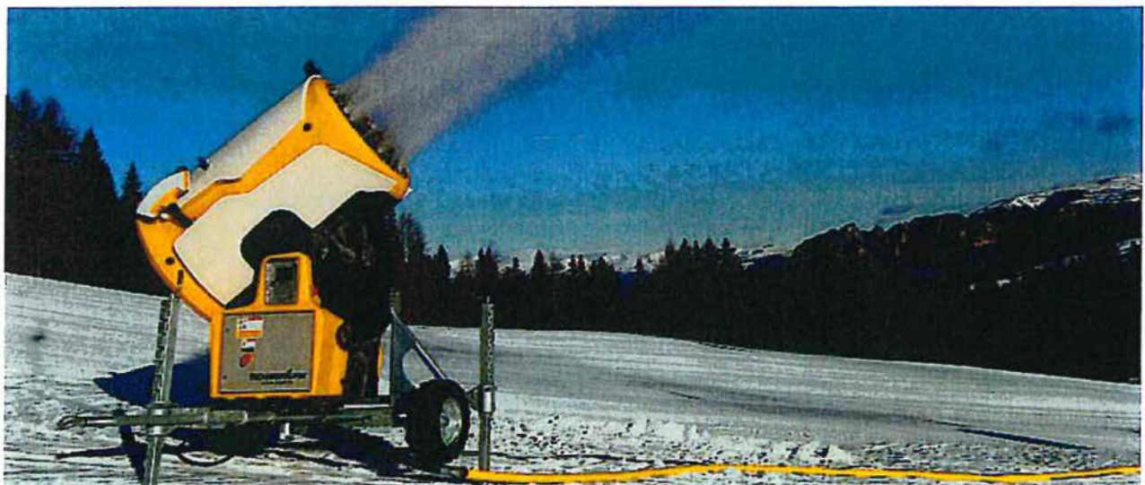
Abbildung 3: Schneekanone der Fa. TechnoAlpin Deutschland GmbH vom Typ „TF 10-AM“
