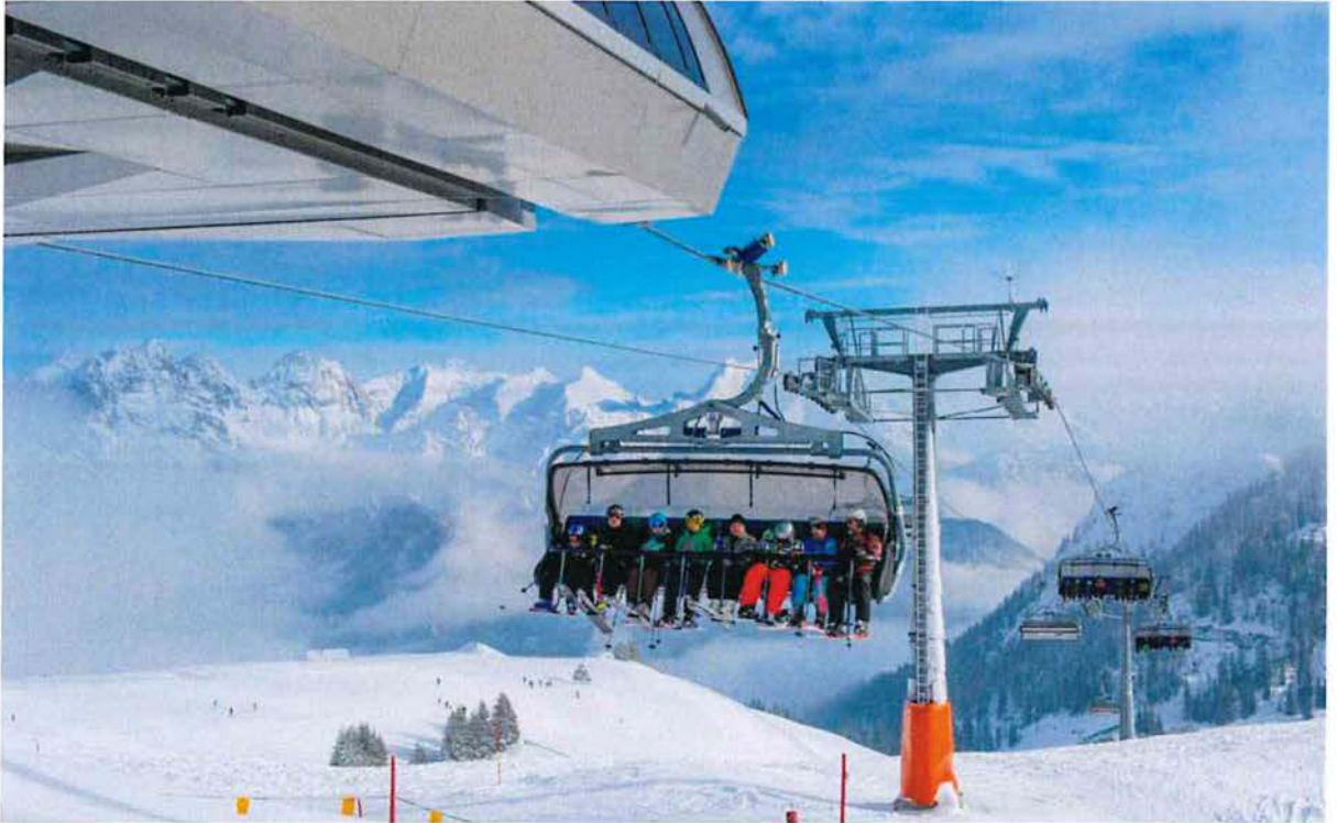
Abbildung 14: Achtersesselbahn mit Haube und Kindersicherung (Fa. Doppelmayr)
