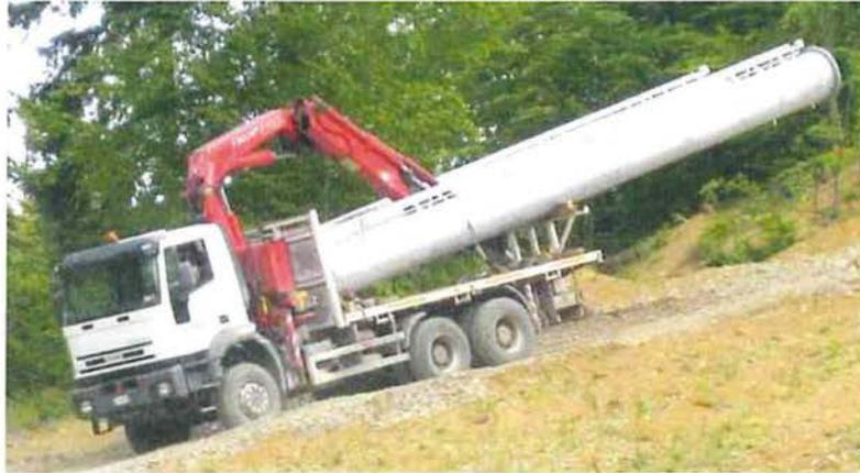
**Abb. 25: Fahrzeug für Stützen- und Seilbahntransporte (3-Achs-Transport-LKW)**
