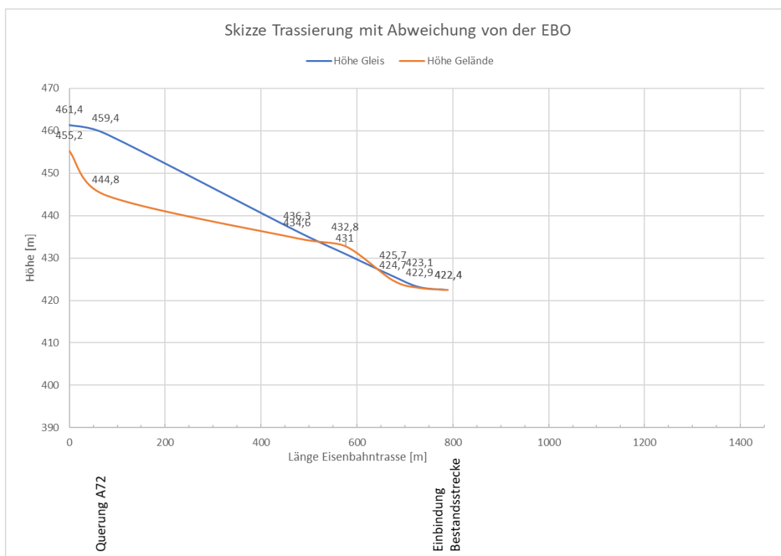
Skizze Trassierung EBO-konform im Vergleich zu Trassierung mit Abweichungen von EBO
