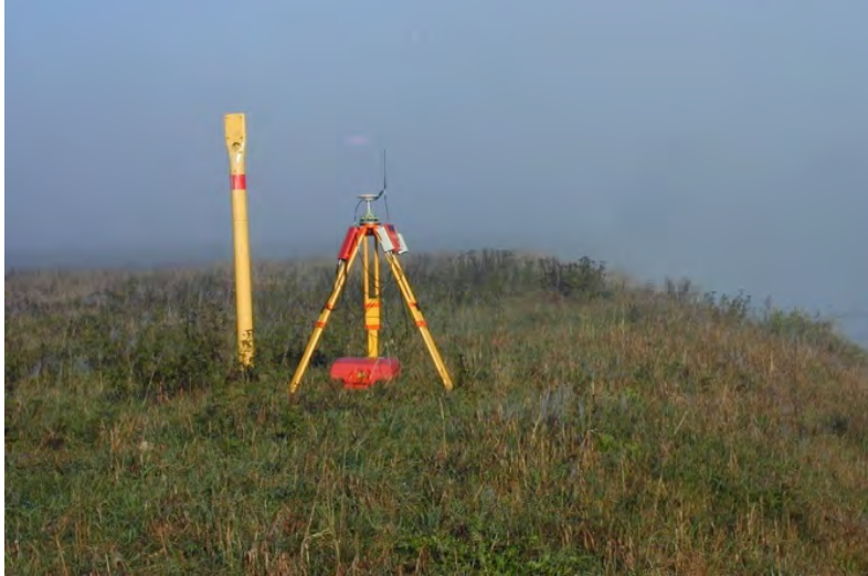
Abbildung 37: Absteckung der Trasse
